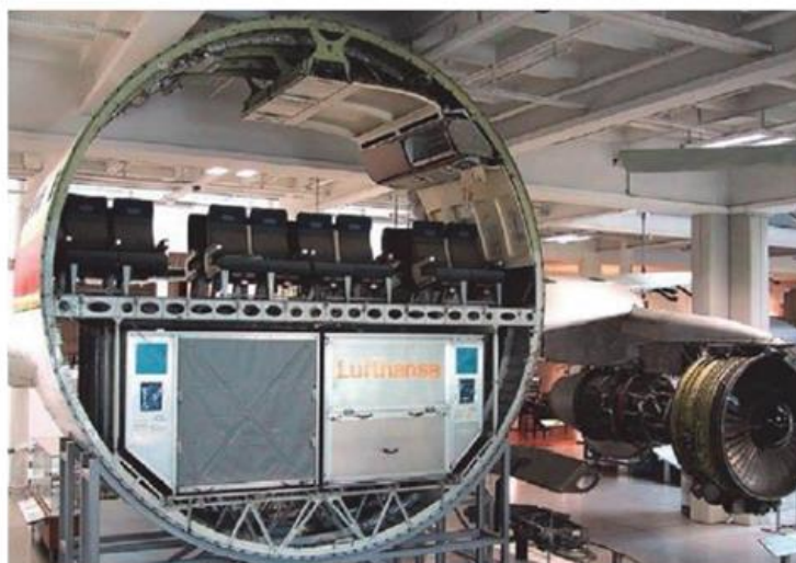
Figura 2 - Seção transversal de uma aeronave de passageiros que apresenta transporte de carga porão
