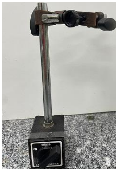
Figura 45 – Base magnética utilizada para fixar os extensômetros durante o ensaio de cisalhamento direto.
