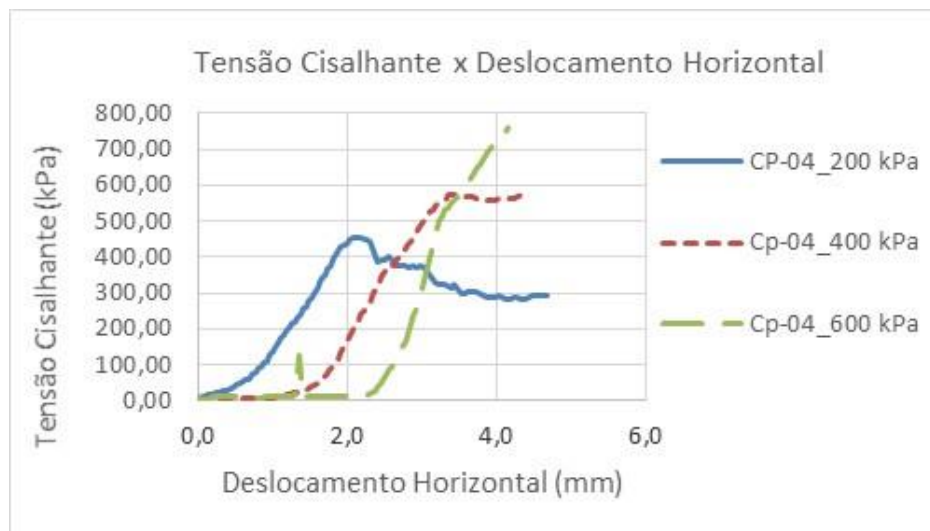
Figura 50 – (a) Tensão cisalhante x deslocamento horizontal, (b) deslocamento vertical x deslocamento horizontal e (c) tensão cisalhante x tensão normal do CP-04.
