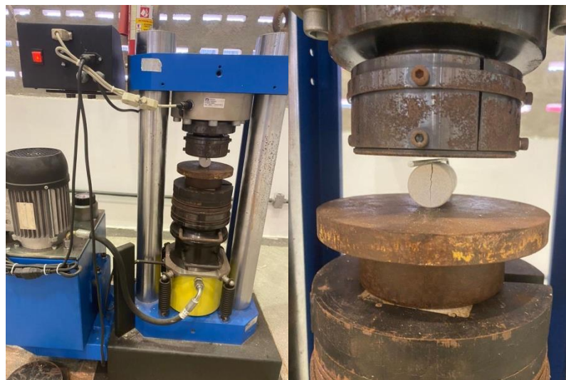
Figura 29 – Procedimento de indução de fratura na rocha carbonática através do ensaio de compressão diametral
