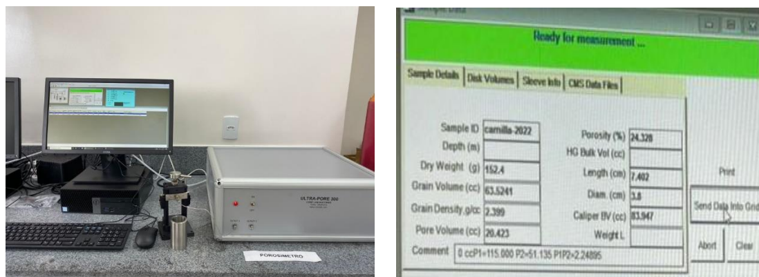
Figura 18 – Ensaio de porosimetria a adsorção a gás. (a) Porosímetro e (b) interface do programa utilizado no equipamento.
