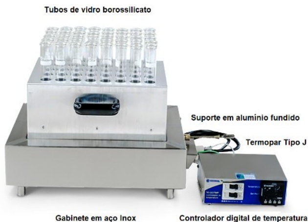
Figura 12 – Fotografia do bloco digestor com destaque para suas principais partes.
