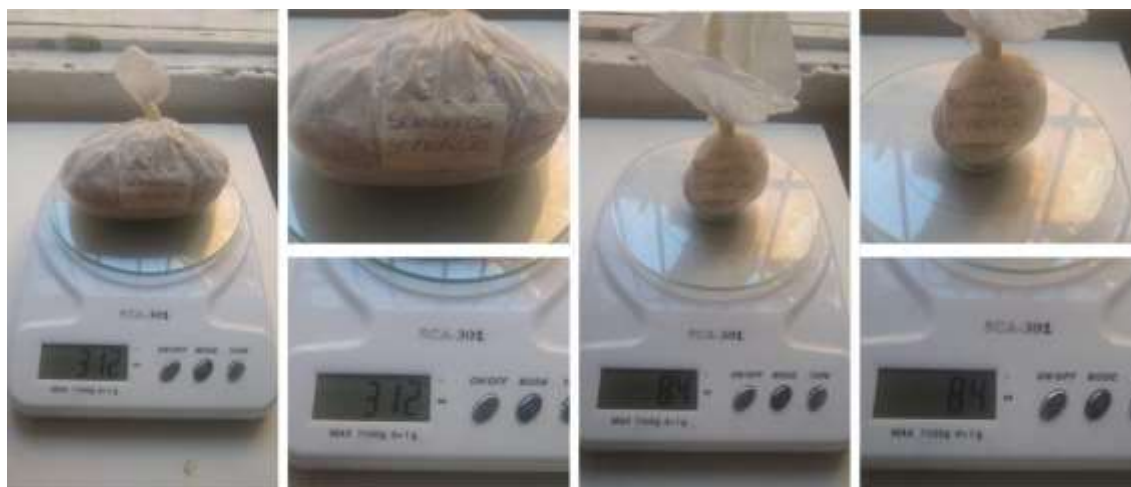
Figura 38: Pesagem dos sedimentos coletados realizados em balança de precisão.
