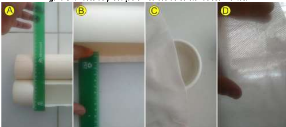
Figura 34: Fases de produção e medidas do coletor de sedimentos.
