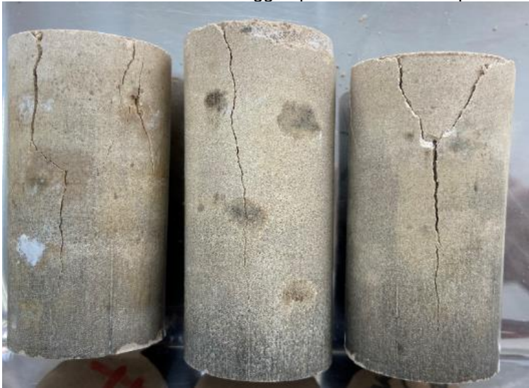
Figura 11 – Rochas sintéticas com vuggs após ensaio de compressão uniaxial
