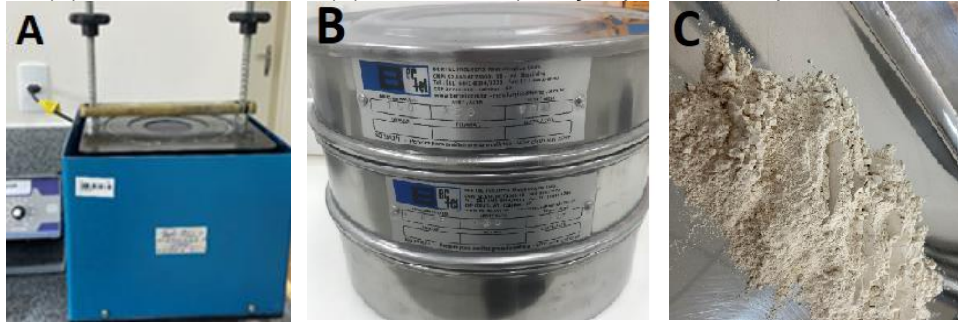
Figura 5 – (A) Peneirador elétrico; (B) Peneiras ; (C) Fração passante de peneira Nº120
