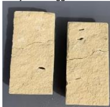
Figura 1 – Simulação de vuggs em rochas carbonáticas
