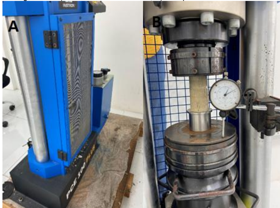
Figura 9 – A) Prensa PCE 100 PLUS; B) Rompimento da rocha
