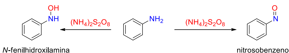
Esquema 35 – Reação de oxidação da anilina para formação da N -fenilhidroxilamina e nitrosobenzeno.
