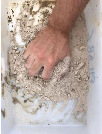
Figura 44 - Adensamento manual (fase úmida).
