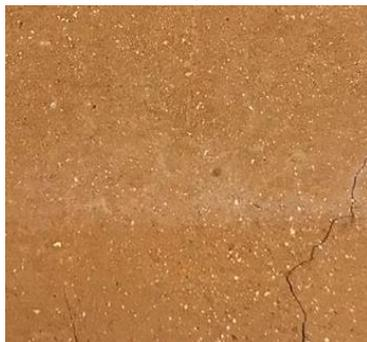
Figura 120 - Mistura 3 |Ataque NaCl.
