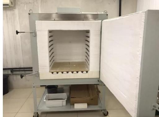
Figura 57 - Placas das reproduções após secagem natural sendo submetidas a primeira queima do processo de cozedura.
