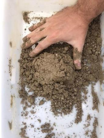
Figura 45 - Adensamento manual (batimento da argila).
