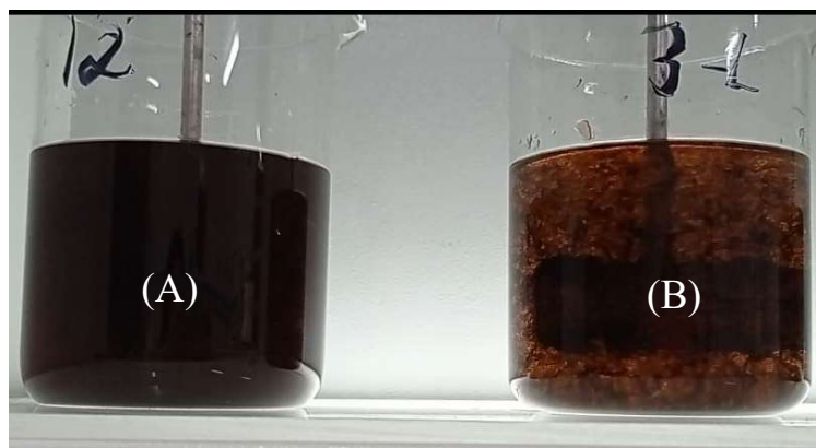
Figura 10 – Etapa de floculação utilizando: a) \text{FeCl}_3 sem pectina e b) com pectina.
