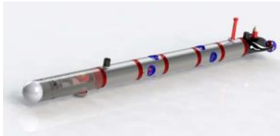
Figura 16 – Exemplo de AUV com diferentes módulos acoplados (MARTA).
