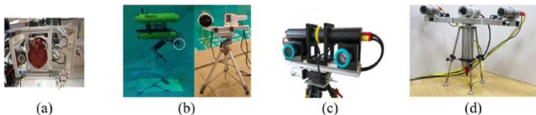
Figura 10 – Sensor de scanner a laser subaquático: (a) sensor de medição de luz estruturado subaquático; (b) sensor de scanner a laser subaquático; (c) scanner a laser de rotação subaquática; (d) sensor de scanner a laser subaquático.
