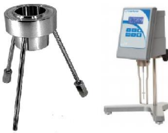
Figura 9 – Exemplos de viscosímetros, o primeiro consiste em um viscosímetro de orifício e o segundo em um rotacional
