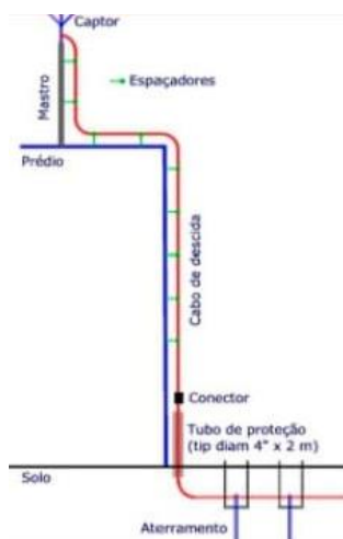
Figura 25 – Esquema simplificado do sistema de proteção contra descargas atmosféricas
