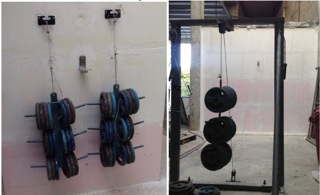
Figura 11 – Fotografias de Ensaios de desempenho estrutural tipo Dispositivo de TV e tipo Dispositivo de Rede para SVVI’s
