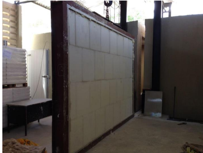
Figura 15 – Fotografia de Ensaio de desempenho acústico para SVVI's, no momento anterior a entrada do SVVI na Câmara de ensaio
