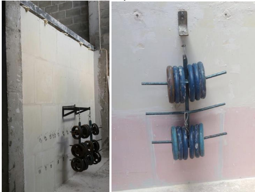
Figura 10 – Fotografias de Ensaios de desempenho estrutural tipo Mão Francesa Padrão e tipo Cantoneira “L” para SVVI’s
