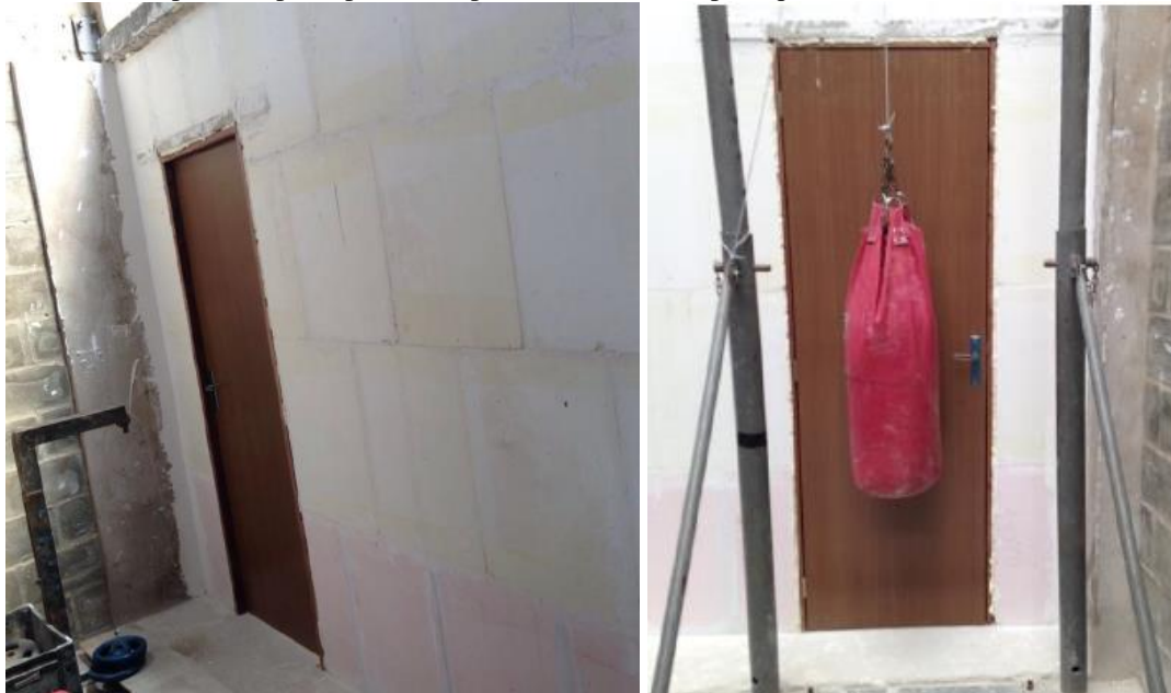
Figura 13 – Fotografias de Ensaios de desempenho estrutural tipo Impactos de fechamento brusco de porta e tipo Impactos Corpo mole na folha da porta para SVVI's
