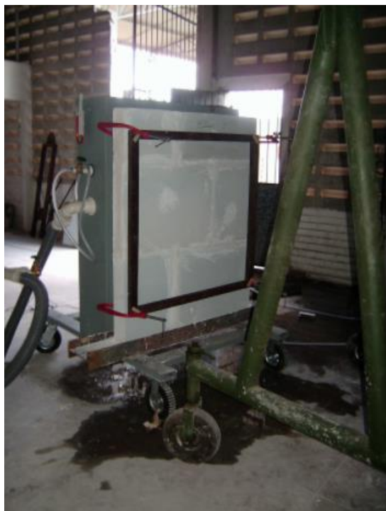
Figura 16 – Fotografia de Ensaio de Estanqueidade contra água para SVVI's no ITEP.
