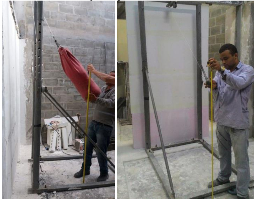
Figura 12 – Fotografias de Ensaios de desempenho estrutural tipo Impactos Corpo Mole e tipo Impactos Corpo Duro para SVVI's
