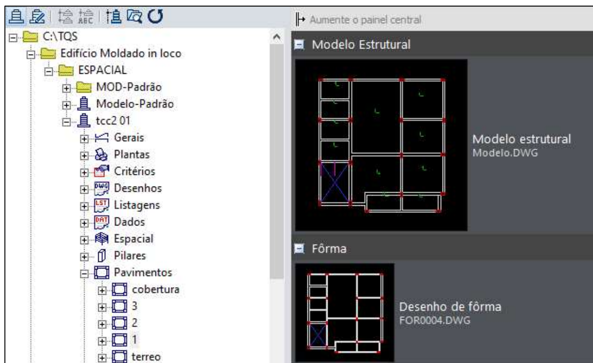
Figura 27 – Árvore do edifício e modelador estrutural.
