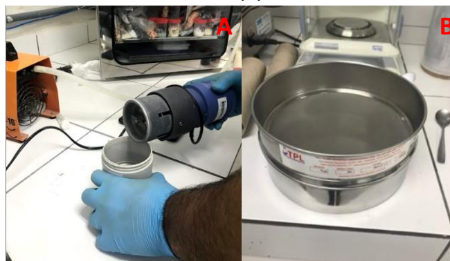
Figura 20 - Etapas de pulverização com moinho analítico (A) e peneiramento na peneira n° 200 (B).
