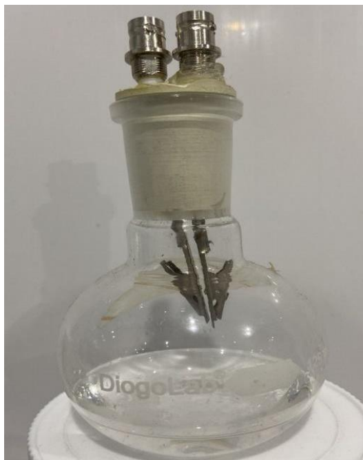
Figura 43- Erlenmeyer com tampa adaptada para aplicação do sensor de umidade
