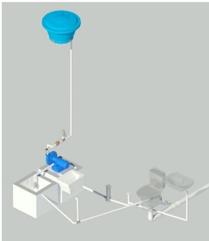
Figura 17 - Disposição geral do sistema de reuso em casa popular modelo
