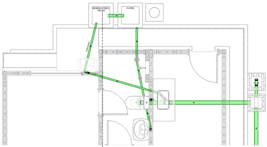
Figura 16 - Planta baixa indicando a disposição geral do sistema de reuso em casa popular modelo
