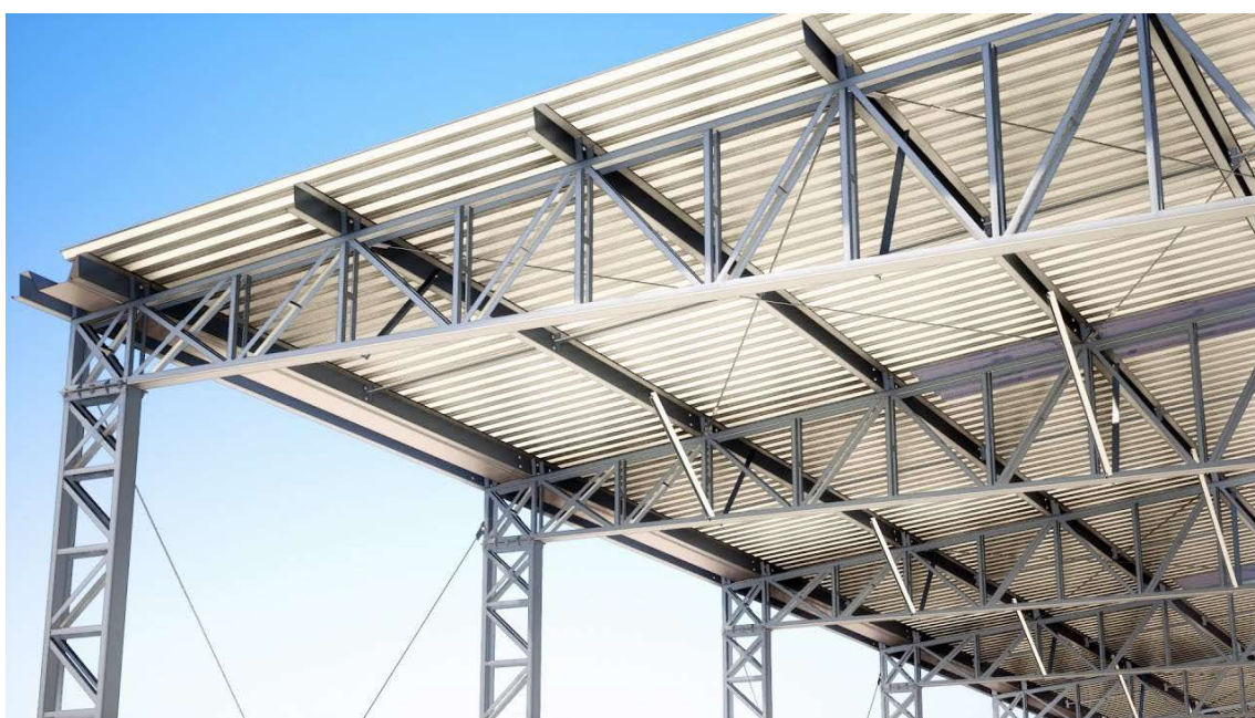
Figura 3 – Pórtico treliçado trapezoidal
