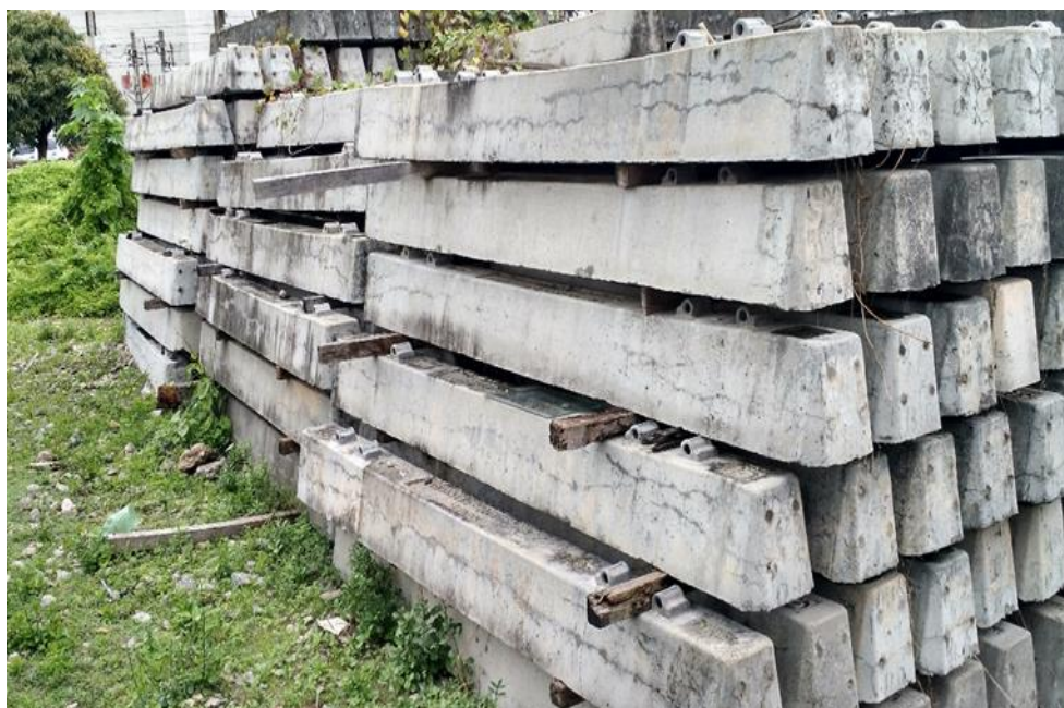
Figura 43 – Fissuras nos dormentes estocados
