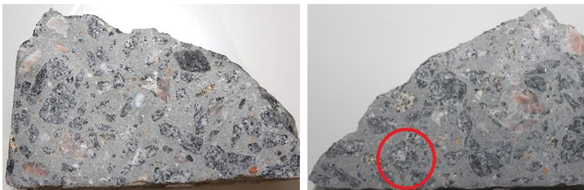
Figura 51 – Cortes realizados na amostra 03 (sem impregnação) e fissura identificada (foto à direita)
