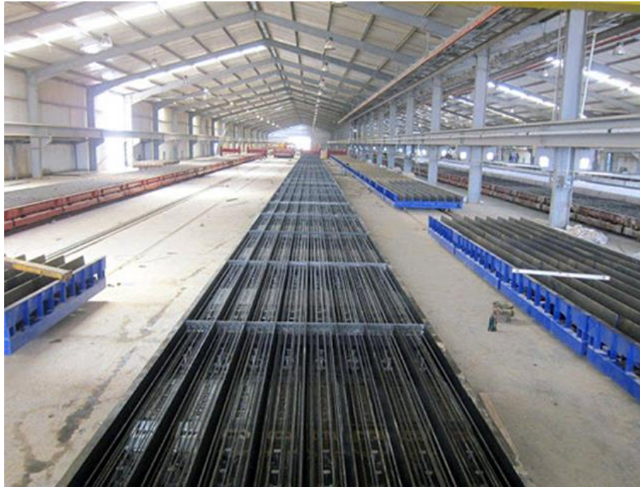
Figura 18 – Sistema de produção long line
