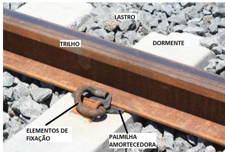
Figura 5 – Principais elementos da superestrutura
