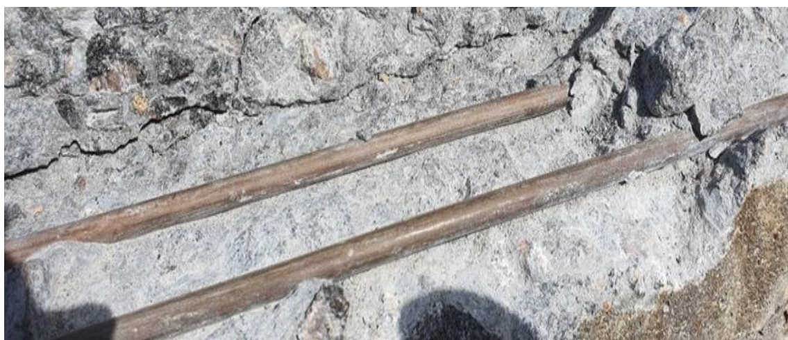
Figura 57 – Vista ampliada dos fios de protensão CP-160 (RB) dos dormentes estudados
