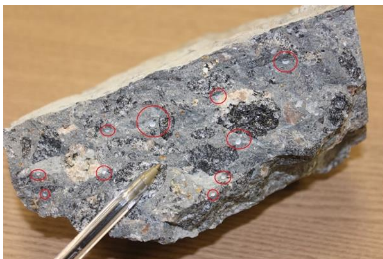
Figura 49 – Presença de inúmeros poros com material esbranquiçado na amostra 02
