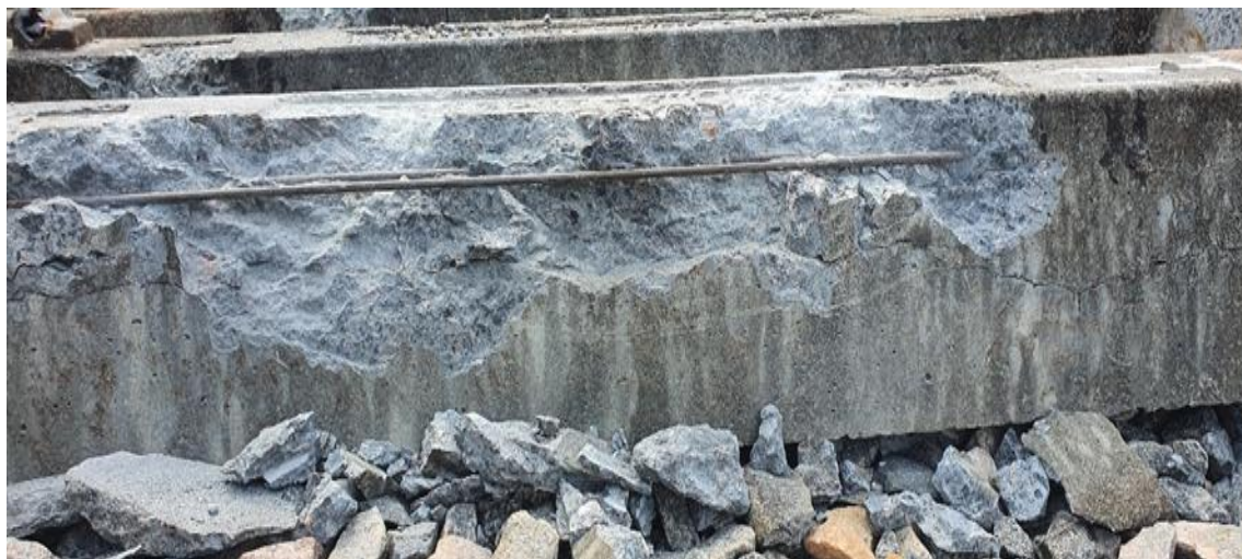
Figura 56 – Análise dos fios de protensão do dormente de concreto protendido
