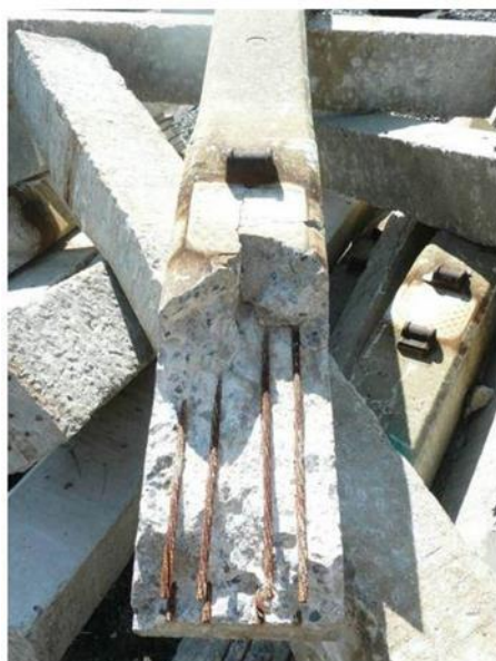
Figura 27 – Dormente afetado por RAA em ferrovia norte-americana
