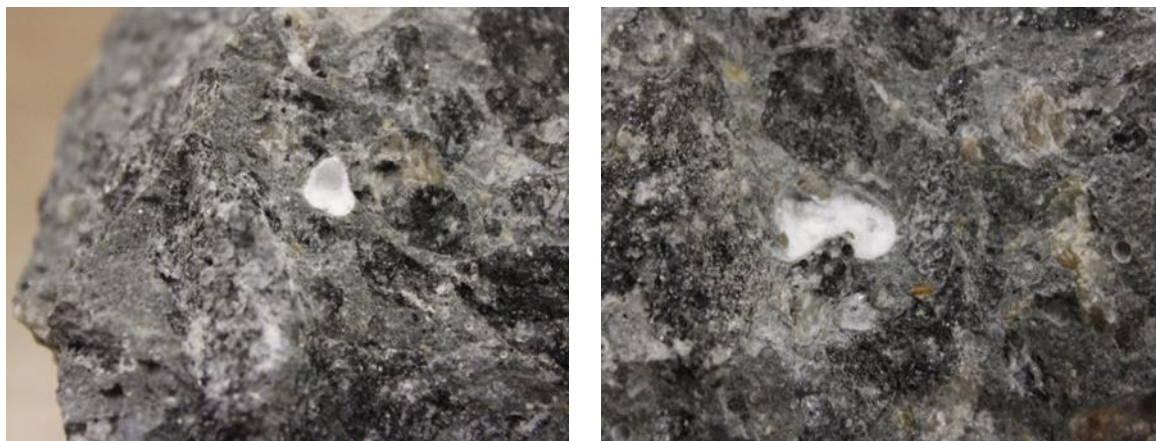
Figura 48 – Vista ampliada dos poros contendo material esbranquiçado na amostra 01
