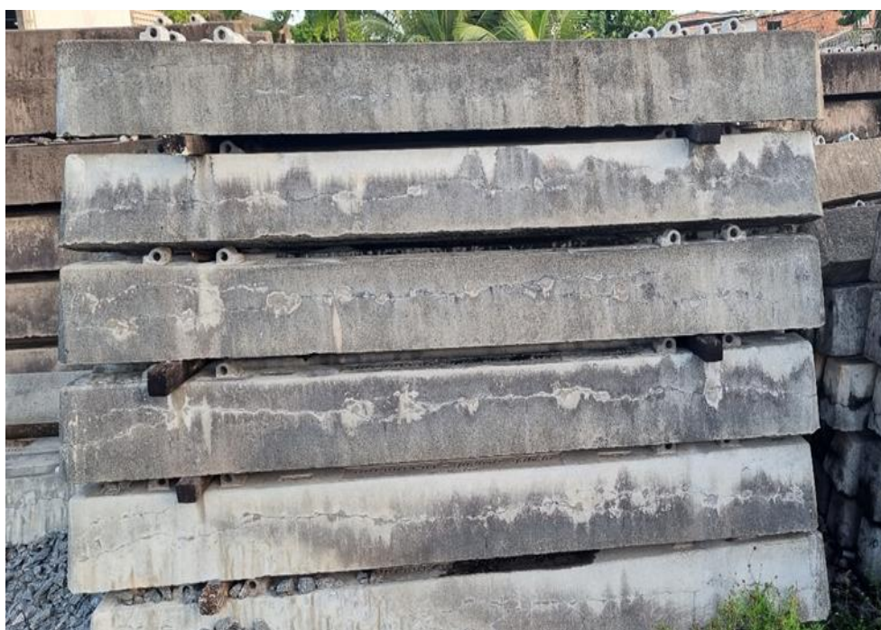
Figura 44 – Fissuras nos dormentes estocados
