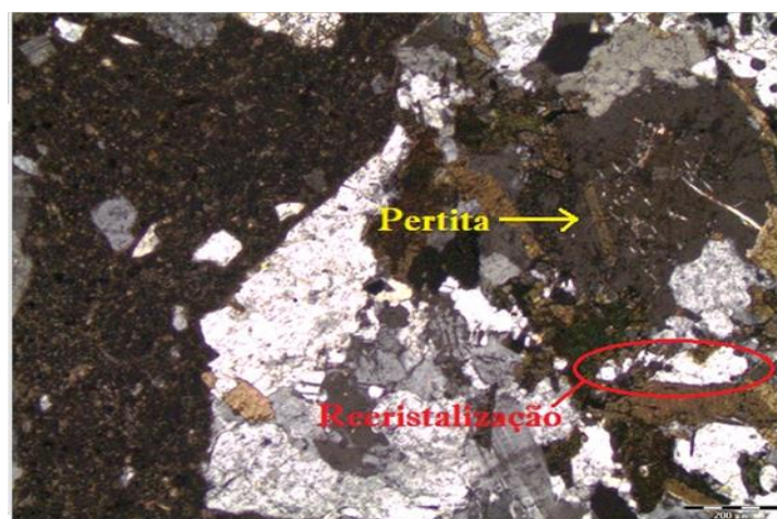
Figura 67 – Presença de Recristalização por subgrão e Pertita no agregado graúdo
