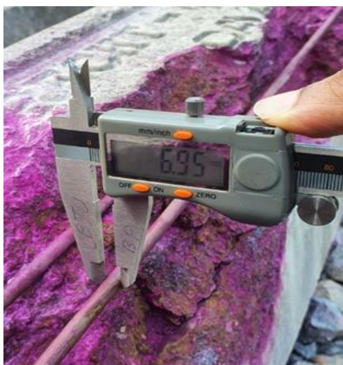
Figura 58 – Verificação do diâmetro do fio de protensão
