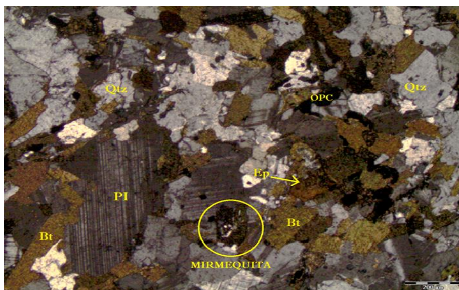
Figura 64 – Minerais presentes no agregado graúdo – Bt = biotita, Pl= plagioclásio, Ep= epidoto, Qtz = quartzo, Opc = minerais opacos
