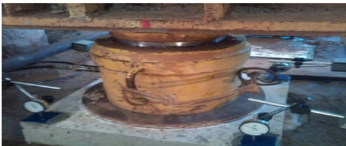
Figura 15.1 – Posição dos defletômetros para verificação dos deslocamentos verticais e horizontais.
