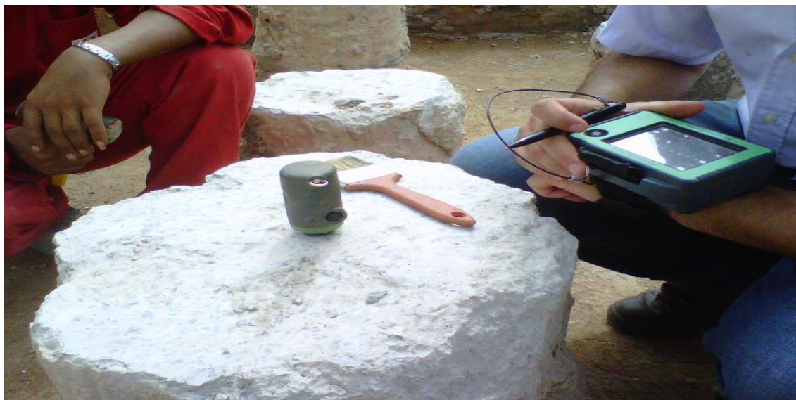
Figura 17 – Após o arrasamento do topo da estaca, de menor qualidade. Procede-se ao nivelamento da sua superfície e colocação de um acelerômetro de alta sensibilidade seguida da aplicação de golpes com um martelo de mão, à esquerda. E a direita, o equipamento que registra as leituras de propagação da onda no corpo da estaca.
