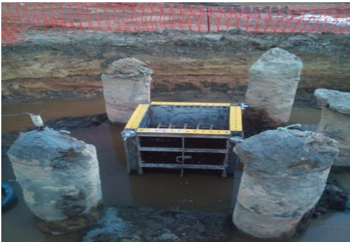
Figura 16 – Disposição das estacas de apoio, de reação, e preparação para concretagem do bloco de coroamento, para montagem da prova de carga na estaca que será ensaiada à compressão.
