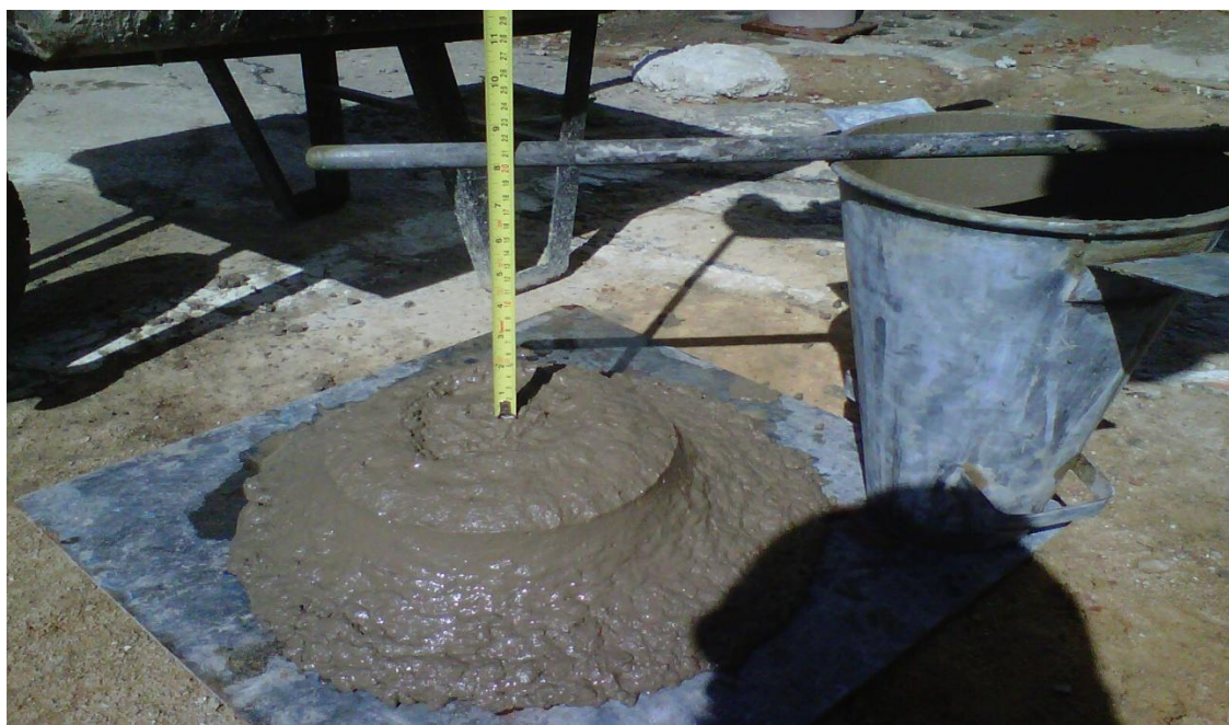
Figura 8 - Controle tecnológico do concreto: Verificação do abatimento/espalhamento( slump test ) de projeto. Deve-se ter bastante atenção nessa etapa, pois um concreto com o slump diferente poderá implicar em uma impossibilidade de bombeamento, integridade no fuste da estaca ou até mesmo problemas de entupimento dos equipamentos.
