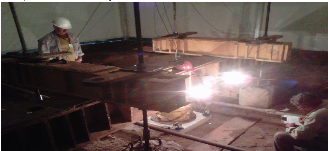
Figura 15 – Prova de carga estática de carregamento lento – slow maintained load test . Toda as anotações de carregamento e deslocamento são registradas ao longo do teste. E ao fundo a estrutura de proteção de apoio que isola a área de teste de possíveis interferências externas.
