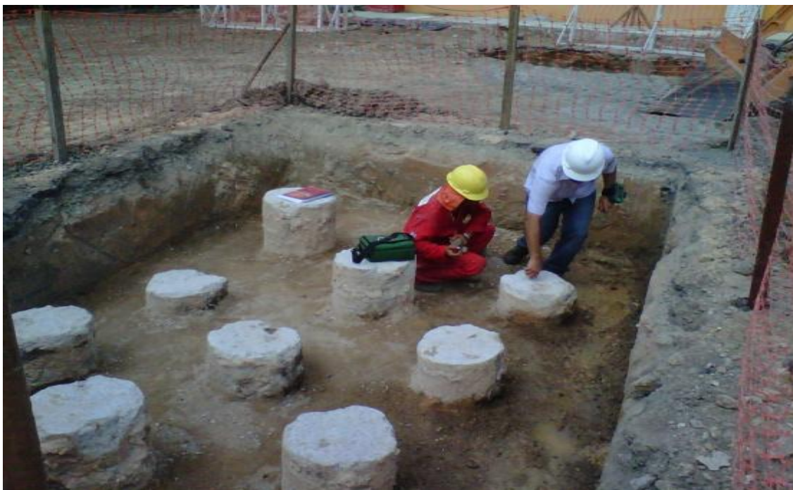
Figura 19 – Procede-se o PIT em todas as estacas selecionadas. É recomendável que a área de realização do teste esteja bem nivelada, de fácil acesso ao operador e seca.
