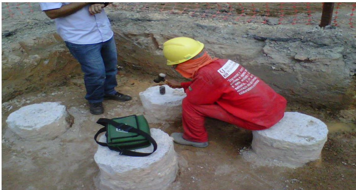
Figura 18 – Aplicação de golpes na superfície da estaca. É usual a aplicação de vários golpes sequenciais, para que o equipamento PIT tire a média dos sinais correspondentes. Isso permite a "filtragem" de interferências randômicas, sobressaindo no sinal apenas as variações causadas pelas reflexões da onda.
