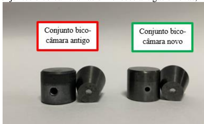
Figura 18 - Conjuntos bico-câmara nas dimensões antigas e novas, respectivamente.
