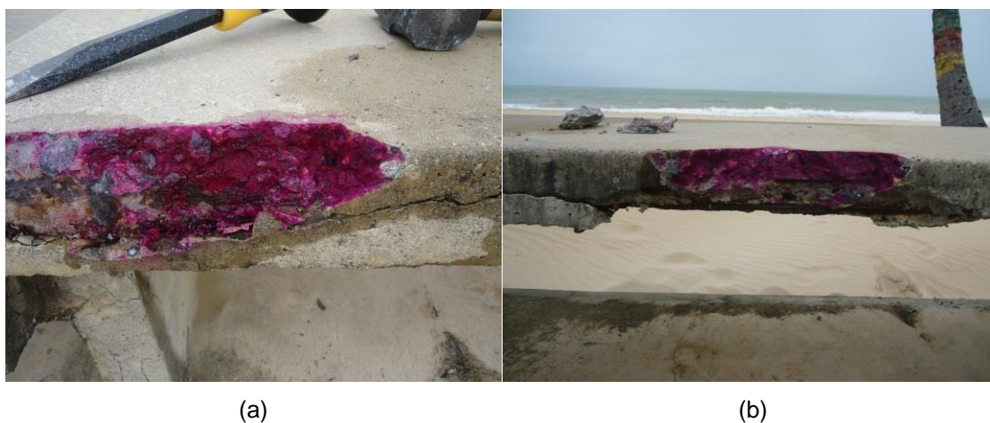
Figura 6.8: Ensaio de carbonatação com aspersão de fenolftaleína (Trecho A)
