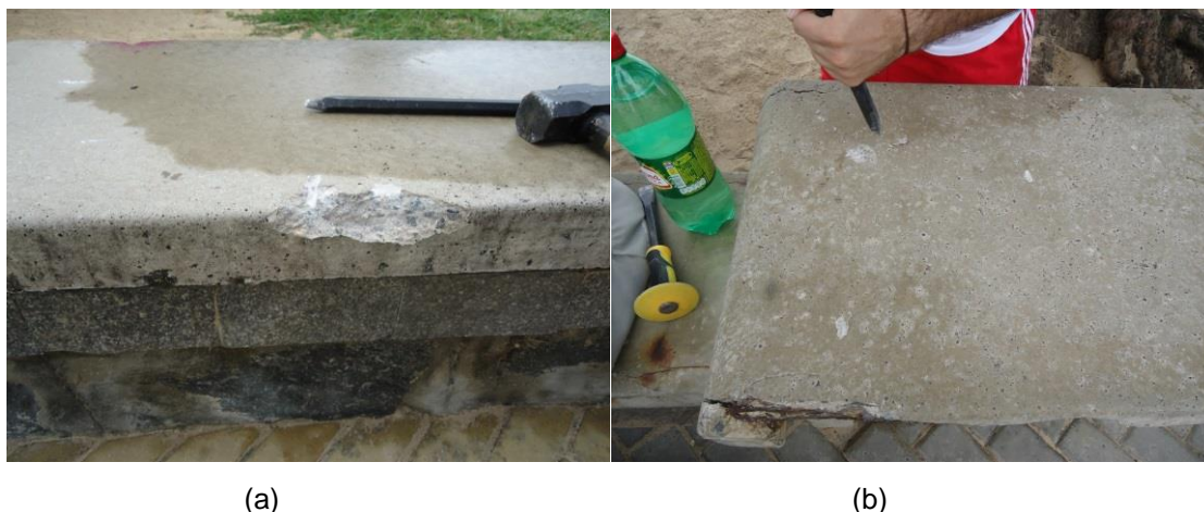
Figura 6.7: Coleta de amostras para ensaio de cloretos totais
