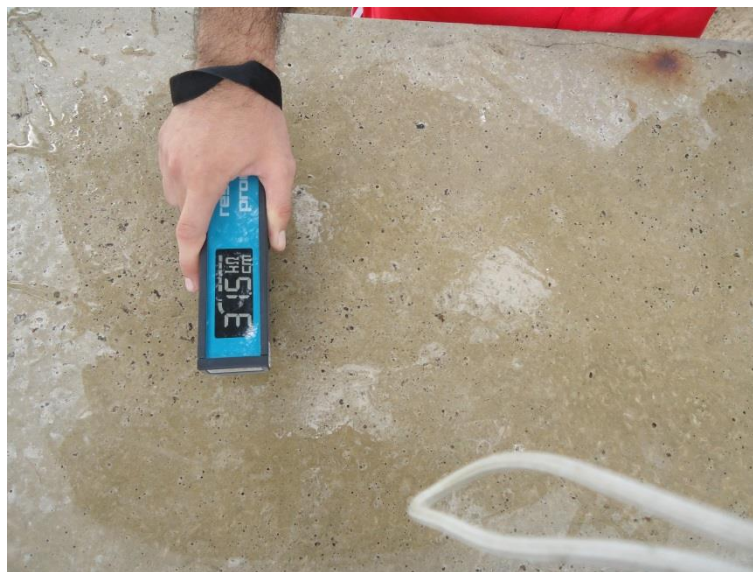
Figura 6.6: Ensaio de resistividade
