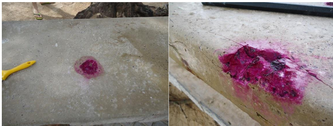
Figura 6.9: Ensaio de carbonatação com aspersão de fenolftaleína (Trecho B)
