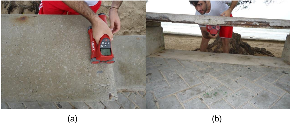
Figura 6.1: Ensaio de pacometria
