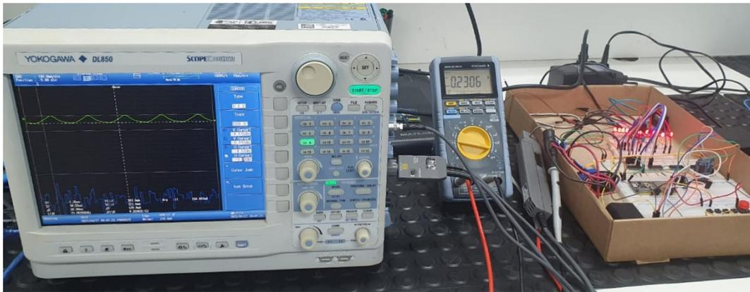
Figura 4.4: Montagem para teste de consumo de corrente com o solenoide (Fonte: o Autor)
