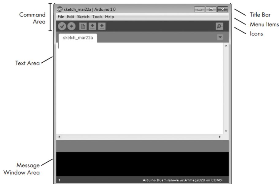
Figura 2.23: Ambiente de Desenvolvimento Integrado (IDE) do Arduino. (Fonte: BOXALL, 2013)
