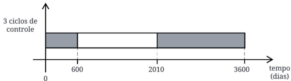
Figura 13 – Definição prévia do intervalo dos 3 ciclos de controle para o reservatório Egg Model .
