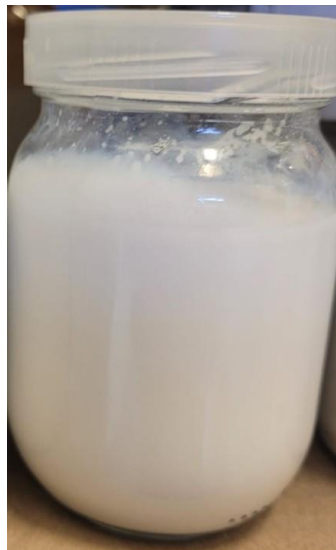
Figura 21 – Protótipo 5 após 90 dias à 55°C
