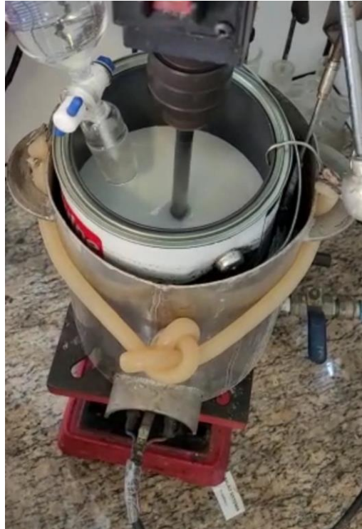
Figura 12 – Sistema adaptado para uso do disco Cowless
