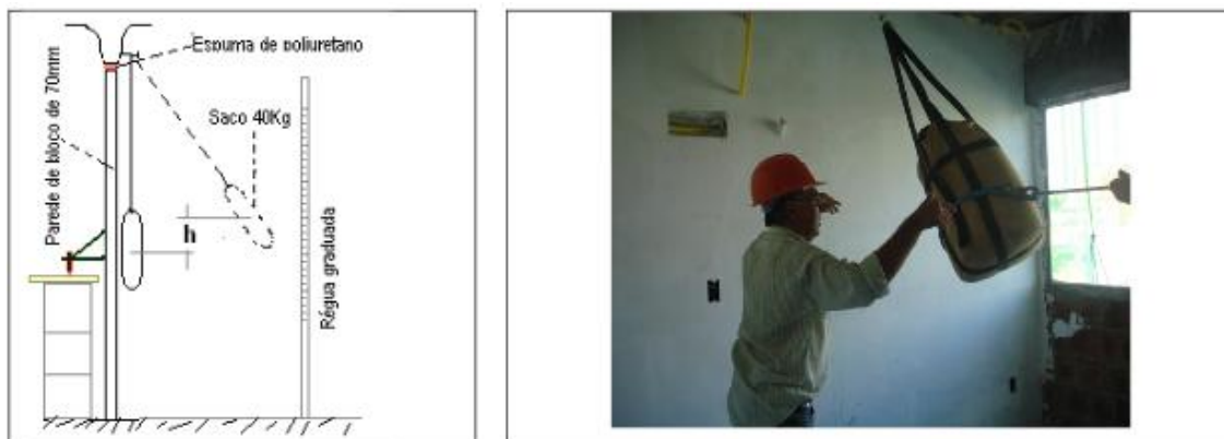
Figura 35 - Esquema de ensaio de impacto de corpo mole. Fonte: Pires e Sobrinho, 2009.
