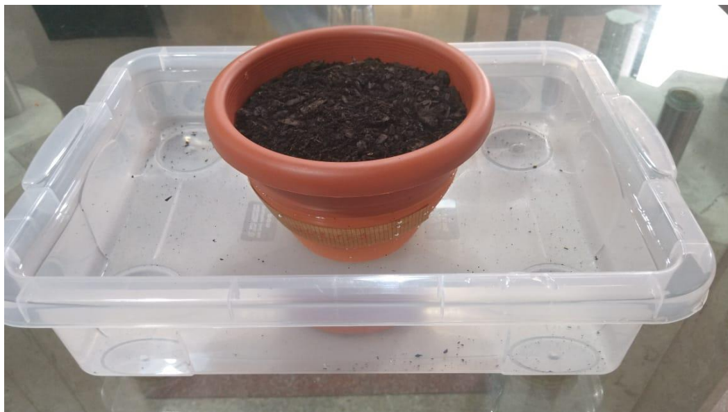
Figura 33 – Vaso com substrato irrigado subsuperficialmente até a saturação
