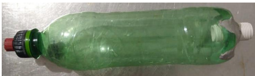
Figura 44 – Reservatório de água com gotejador
