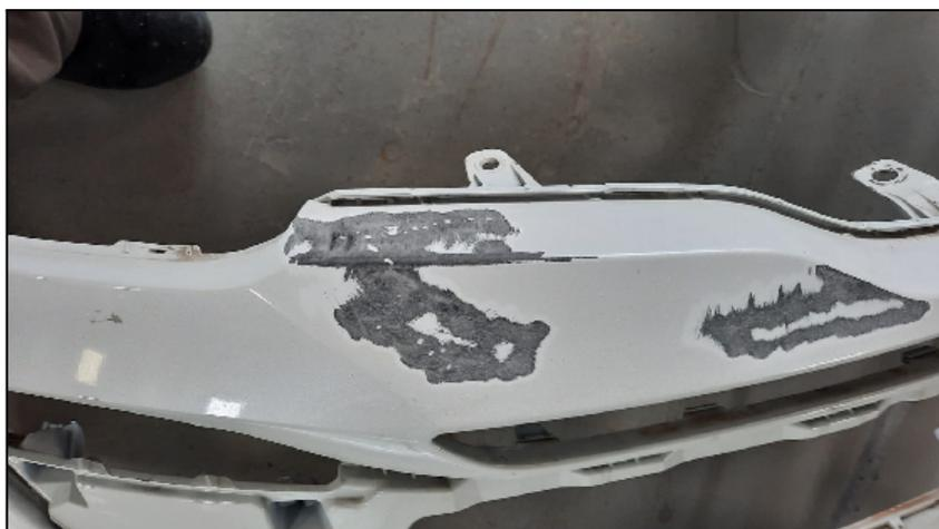
A massa aplicada para recuperação dos para-choques é do tipo adesiva para peças plásticas e serve para preencher espaços da peça que foram danificados e recuperação estrutural de reforço, feita de plástico reforçado com fibra de vidro, apresentada na Figura 35.
