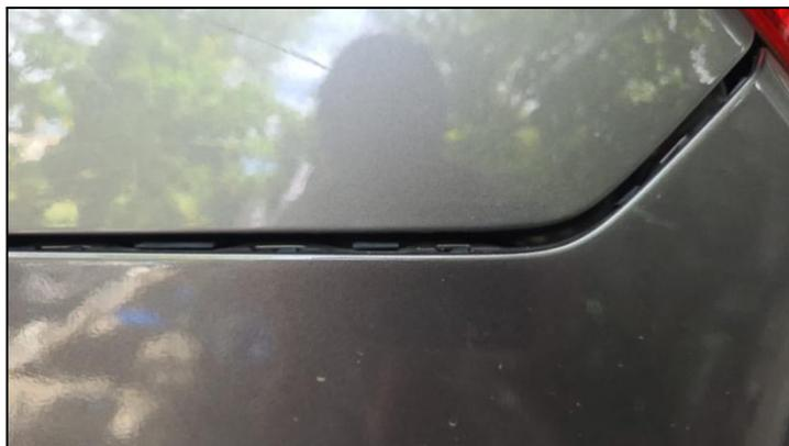
Na Figura 39, podemos ver uma folga no encaixe do para-choque com o para lama devido à quebra das presilhas de encaixe. Comparando o encaixe do para-choque com o painel traseiro esquerdo e direito podemos ver a diferença de encaixe, na Figura 40, de como deveria ser e como ficou após uma batida de suave proporção.
