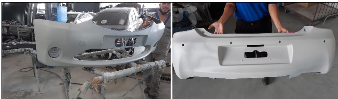
Nos três para-choques da oficina B, observa-se que os defeitos, derivados dos acidentes, apresentam-se em pontos de fragilidade e tensão. Esses pontos são equivalentes a pontos derivados de defeitos de design por instabilidades dimensional, como áreas com curvatura, furos de acoplamento, vigas e abas de conexão, espessuras finas de parede, onde cargas de tensão extremamente altas podem se desenvolver (FISCHER, 2003).
