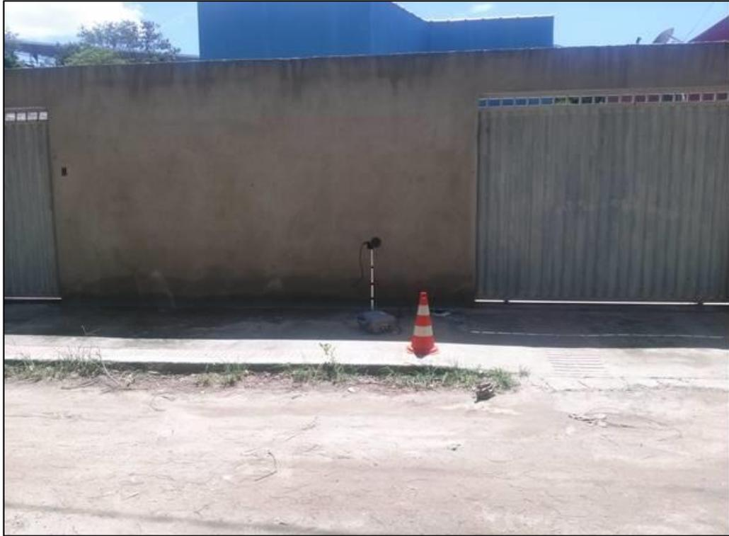
**Figura 13:** Equipamento fixado para registro sismográfico proveniente de detonações. (Vila Velha/ES)
