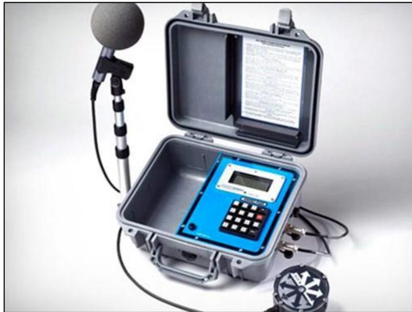
**Figura 12:** Equipamento fixado para registro sísmográfico proveniente de detonações.
