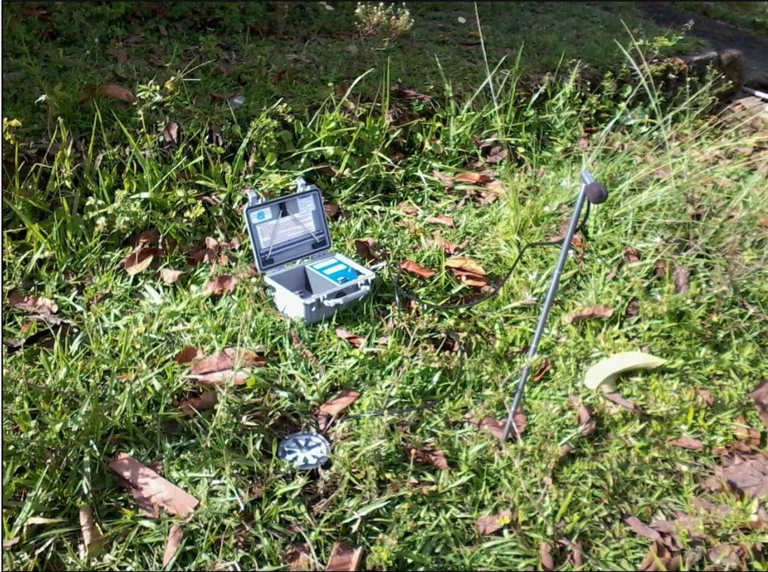
**Figura 15:** Equipamento fixado para registro sismográfico proveniente de detonações (Camaragibe/PE).
