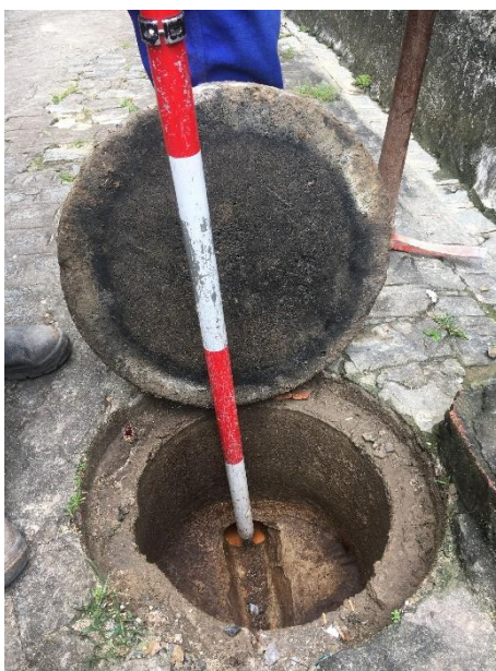
Figura 32: Coleta da Profundidade da Caixa
