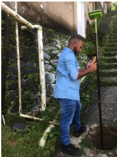
Figura 40 e 41: Coleta da profundidade da Caixa
