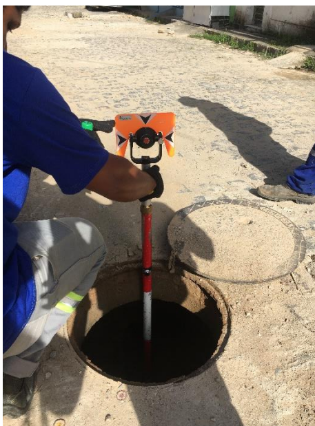
Figura 33: Coleta da Profundidade do Poço de Visita
