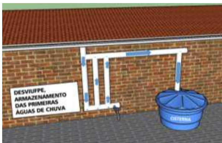
Figura 9 – Dispositivo de desvio das primeiras águas desenvolvido pelos pesquisadores da UFPE
