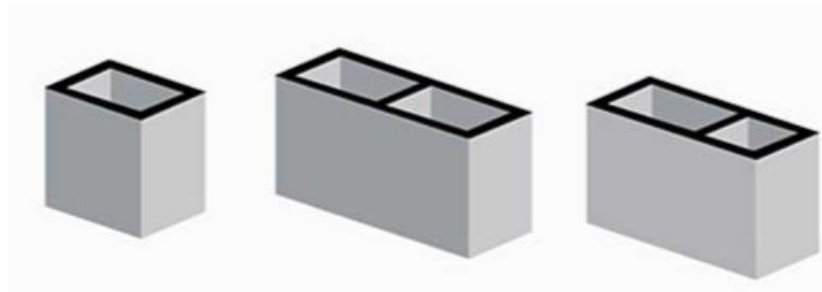
Figura 16 - Blocos de comprimentos 20, 40 e 35, largura 15 cm e altura 20 cm.
