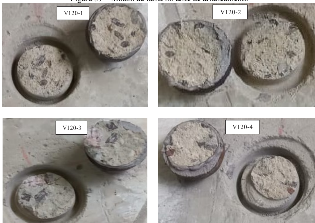
Figura 39 – Modos de falha no teste de arrancamento
