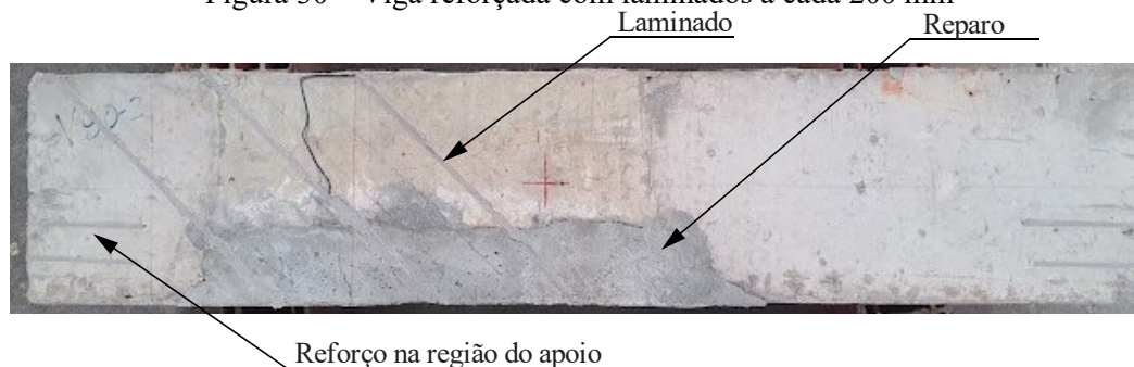
Figura 30 – Viga reforçada com laminados a cada 200 mm
