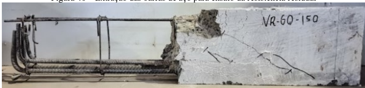
Figura 40 – Extração das barras de aço para ensaio da resistência residual
