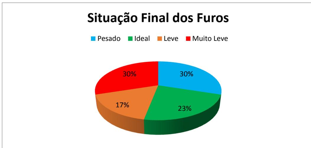
Figura 42 - - Situação Final dos furos quanto a sua relação com a face da bancada.
