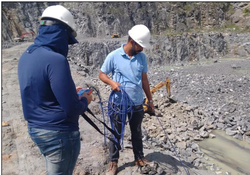
Figura 20 - Medição das inclinações do furo na Pedreira Esperança.
