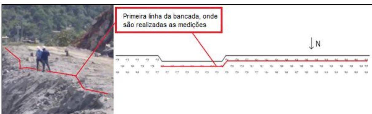
Figura 26 - Linha onde são realizadas as medições de inclinação usando o inclinômetro.
