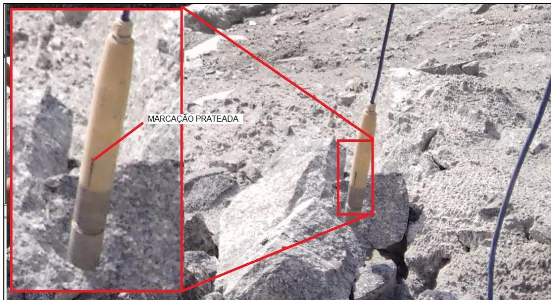
Figura 27 - Marcação prateada indicando a posição que deve estar de frente para a bancada.
