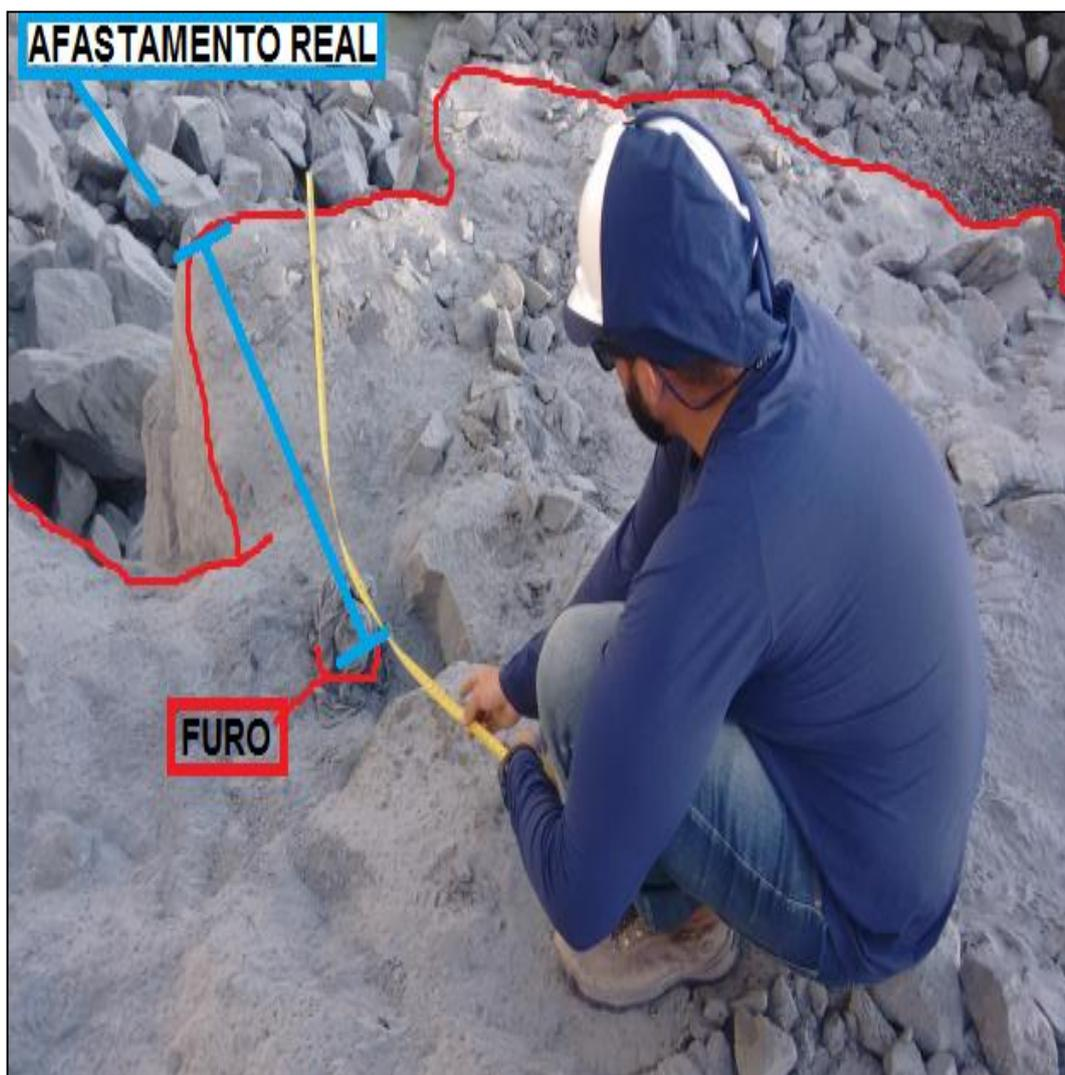
Figura 29 - Medição do afastamento real
