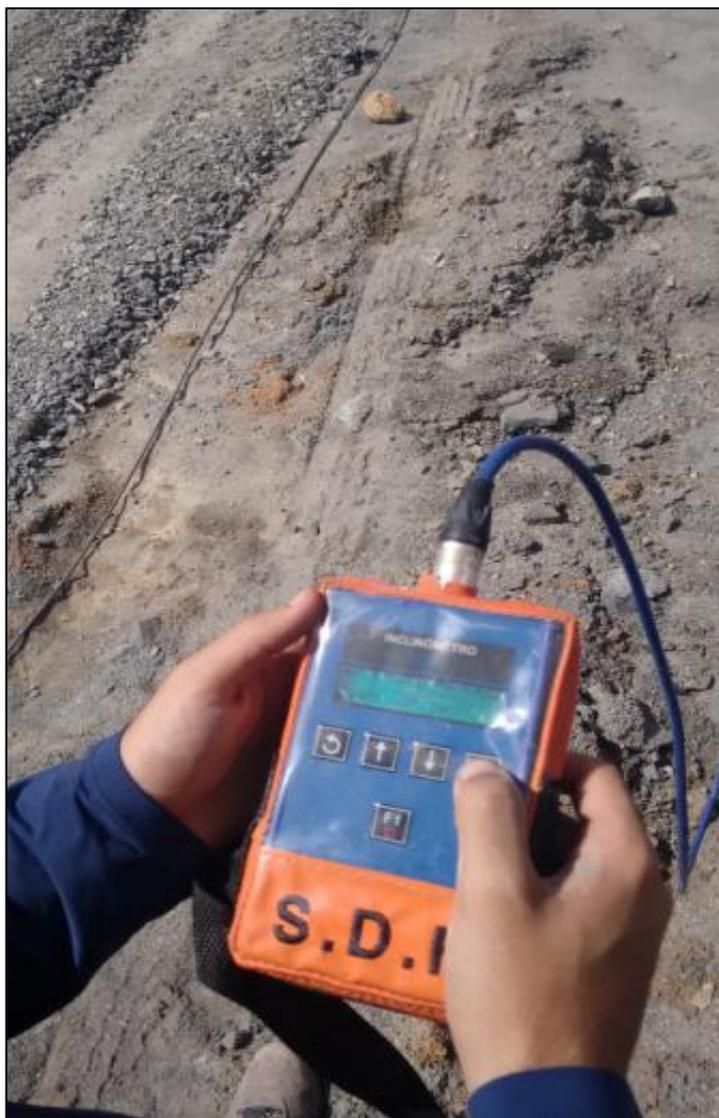
Figura 28 - Display SDF do inclinômetro da ZTEX
