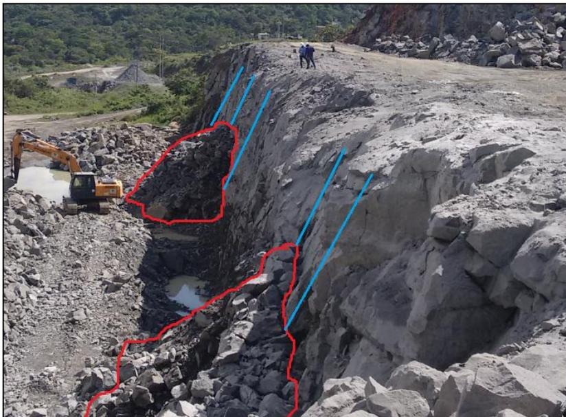
Figura 39 - Imagem mostrando a face da bancada, e em vermelho material que impossibilita a obtenção completa do perfil da face nos furos.
