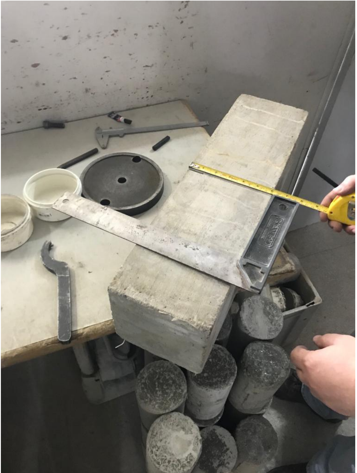
Imagem 3 – Conferição das medidas de um corpo de prova prismático
