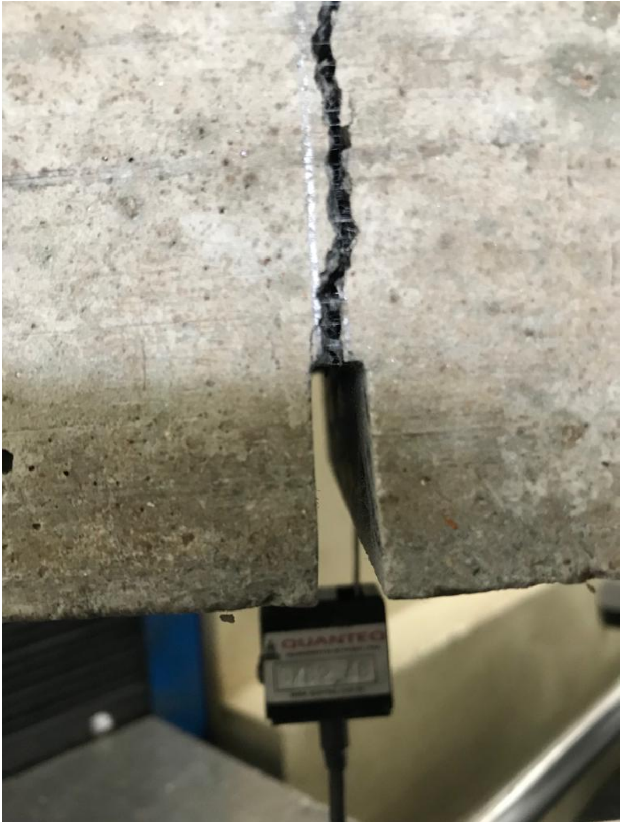
Imagem 6 – Fibras em funcionamento dentro do corpo de concreto durante o ensaio de tração na flexão
