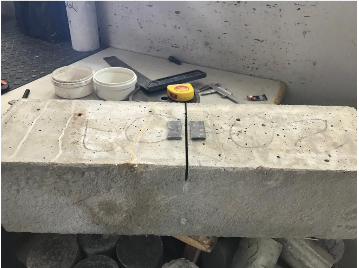
Imagem 4 – Detalhe do entalhe e das bases coladas para fixação do “Clips”
