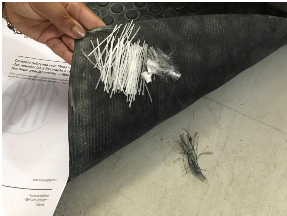
Imagem 1 – Macrofibras poliméricas à esquerda e à direita; e microfibras no centro
