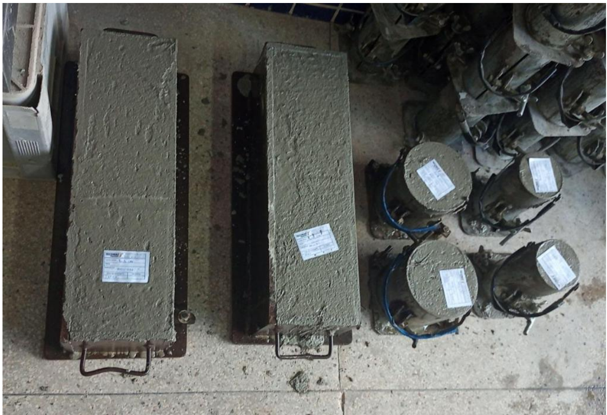
Imagem 2 – Moldagem dos cp's cilíndricos e prismáticos
