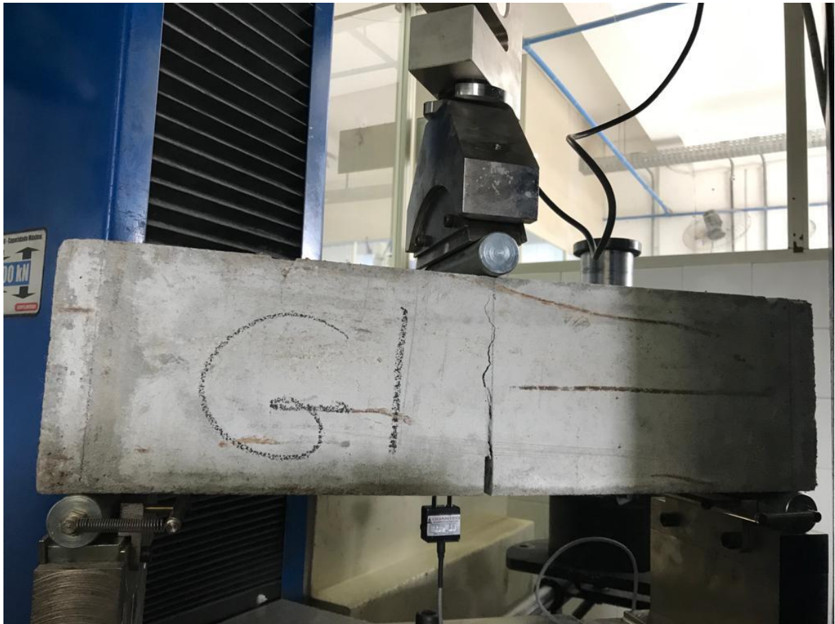
Imagem 5 – corpo em processo de ensaio de tração por flexão
