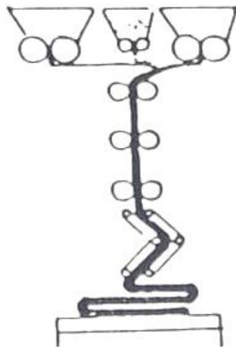
Figura 3 - Laminação Vertical da massa.
