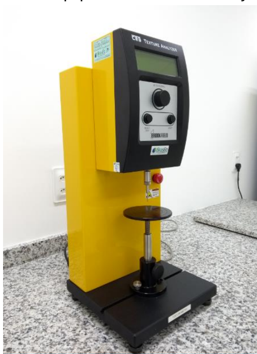
Figura 5 - Equipamento Texture Analyzer CT3 Brookfield.
