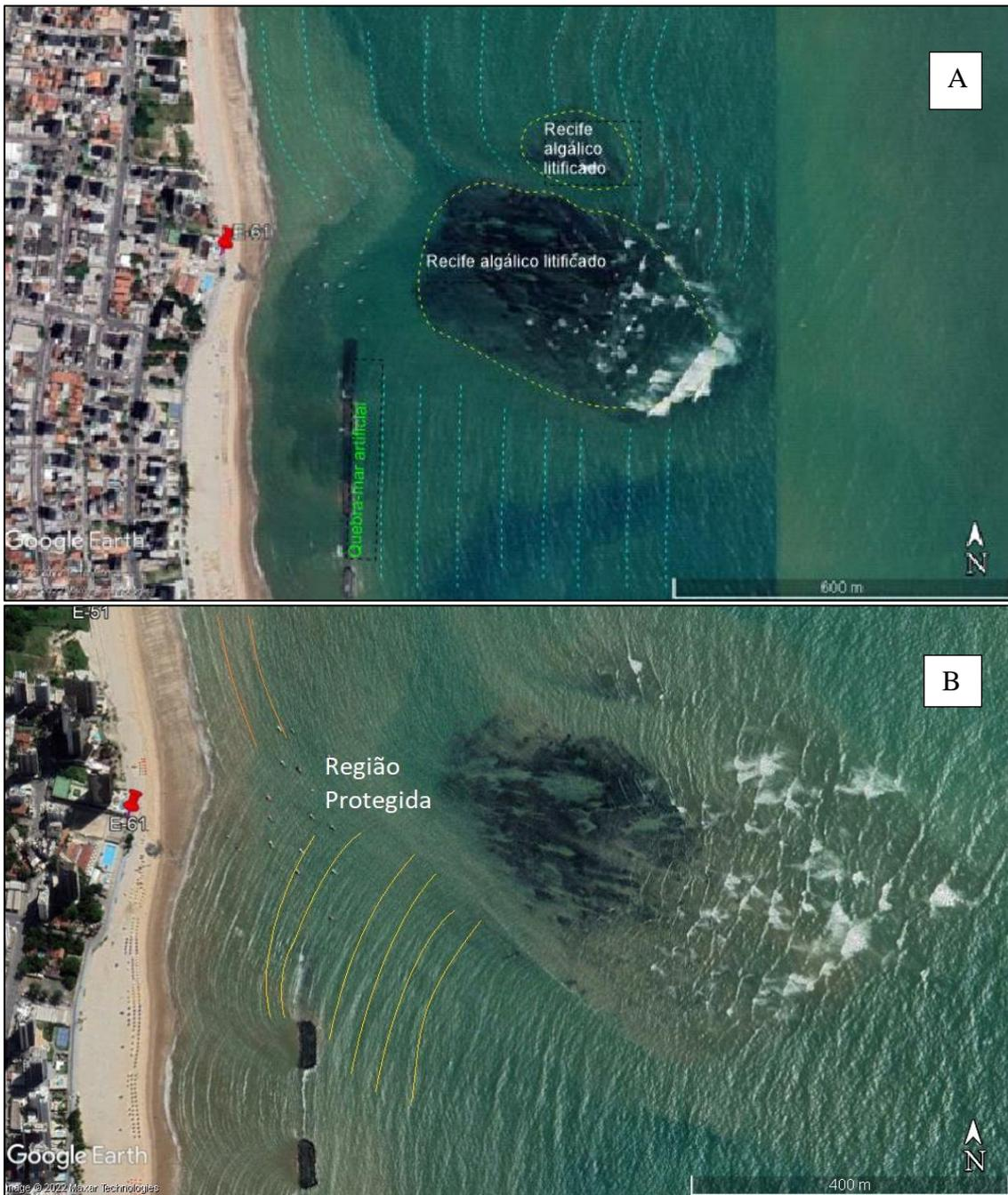
Figura 6.7.1.2. Área próxima a estação E61. A - Representação esquemática mostrando os recifes algálicos litificados, chamados de Abreus, na praia de Candeias (círculos tracejados em amarelo), o quebra-mar artificial e as linhas de ondas (tracejados em ciano). B – Detalhes da difração das ondas que ocorrem entre o quebra mar e o recife algálicos (linhas amarelas), com perfil situado próximo a região abrigada. (Fonte: modificado de Google Earth, A-Outubro de 2021, B-Agosto de 2021).
