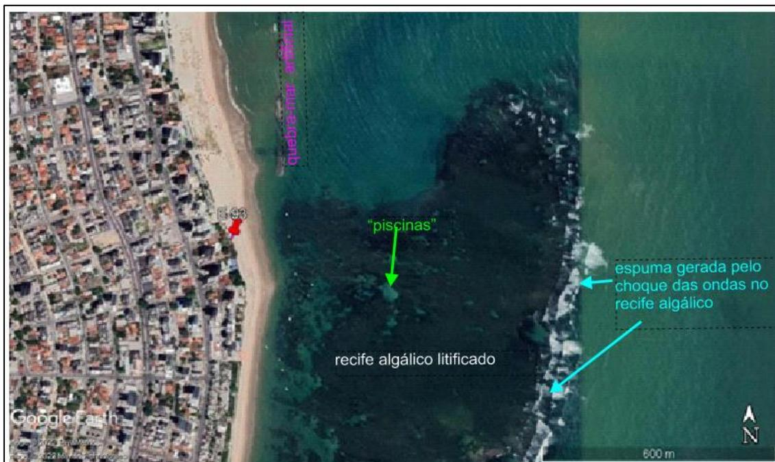
Figura 6.8.1.2. Visão mais ampla da região da antepraia mostrando a presença do quebra-mar, cujo início influencia devido ao estreitamento entre essa estrutura e o recife algálico, extensão do recife algálico e a diferença da cota na porção offshore da rocha, que quebra a chegada da onda, observada na espuma formada (Fonte: modificado de Google Earth, Outubro de 2021).
