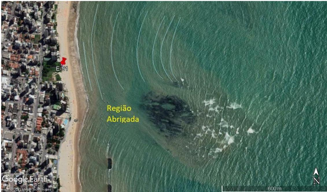
Figura 6.6.1.2. Os bancos algálicos promovem a difração das ondas (linhas em azul claro) que, por sua vez, atingem a praia de paralelamente a linha de costa. E, como situa-se muito próxima a região abrigada, as ondas que incidem sobre a área do perfil são predominantemente frontais. (Fonte: modificado de Google Earth, Outubro de 2021).
