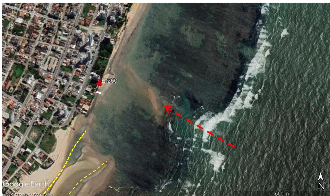
Figura 6.13.1.1. Imagem esquemática mostrando a posição da Estação 260 (E260) onde há estrutura rígida (enrocamento; cerca de 13m do RN, linha branca). As linhas tracejadas em cor amarela são os canais fluviais secundários que meandram nessa região da foz do Rio Jaboatão. A vermelha, tracejada, mostra o ponto de abertura e rebaixamento no banco algálico (Fonte: Modificado do Google Earth, Agosto de 2021).
