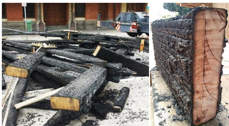
Figura 1.7: Secção de peças estruturais após serem submetidas a altas temperaturas. Fonte: MARTINS, 2016
