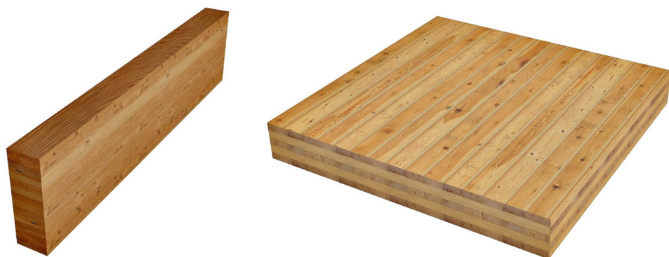
Figura 1.3: À esquerda: madeira lamelada colada (MLC). À direita: madeira lamelada colada cruzada (CLT) Fotos: Structure Craft (acessado em setembro de 2022).
