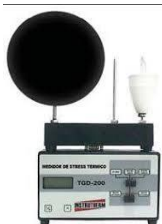
Figura 5 - Modelo de termômetro TGD 200 utilizado nas medições realizadas
