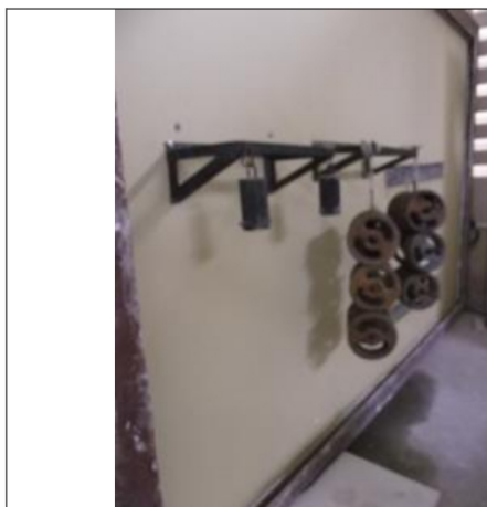
Foto A12- Sistema A' sob carga de 50N por ponto
