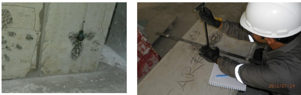
Figura 4 – Detalhes de esfera utilizada no impacto de corpo duro e medição da endentação provocada
