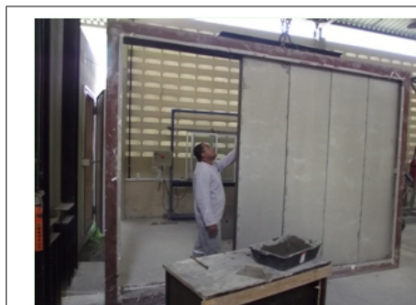
Foto 1 - Montagem elemento com união de painéis utilizando argamassa cimentícia juntas verticais
