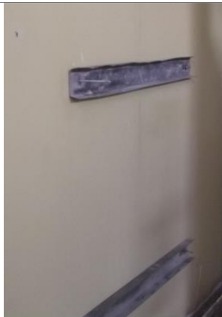
Foto B3- Aspecto da parte posterior sem manchas de umidade após 7 horas de ensaio.
