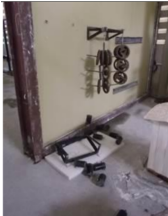
Figura 12 - Ensaio de peça suspensa
