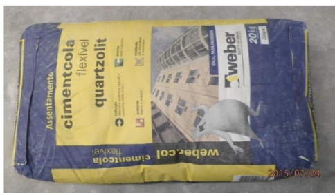
Figura 2 – Argamassa de assentamento dos painéis utilizada nas vedações aporticadas.
