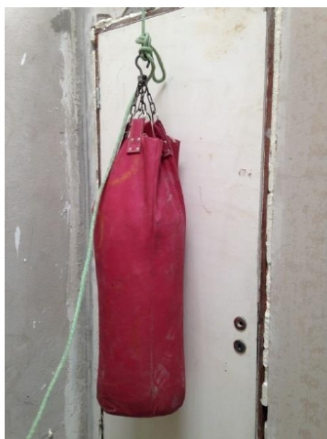
Figura 8 - Equipamento posicionado para ensaio de impacto de corpo mole na folha da porta interna
