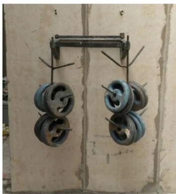
Figura 5 – Fixação da mão-francesa e o carregamento
