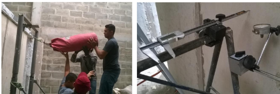
Figura 3 – Vista do ensaio de impacto de corpo mole
