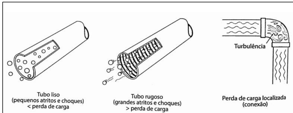
Figura 14 – Fatores na tubulação que influenciam na perda de carga
