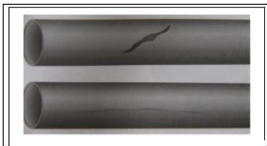
Figura 19 - Ruptura em tubo soldável de PVC por impacto
