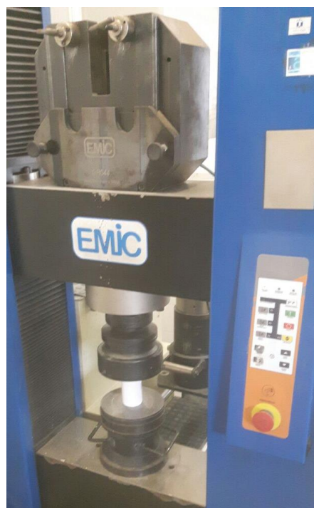
Figura 9 - Ensaio de Resistência à compressão em corpos de prova cilíndricos
