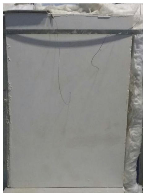
Figura 12 – Posicionamento dos termopares nas placas
