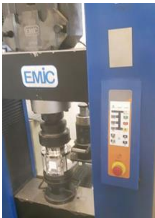
Figura 8 - Ensaio de Resistência à compressão em corpos de prova retangulares
