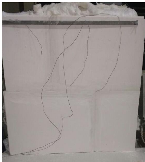
Figura 15 - Posicionamento dos termopares na face externa da parede 2
