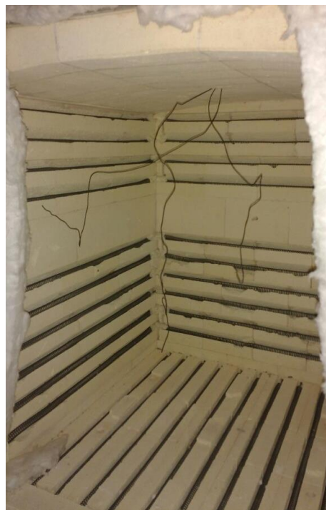
Figura 14 – Posicionamento dos termopares no interior do forno
