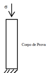
Figura 5 – Esquema do Ensaio Uniaxial, com o corpo de prova, na vertical, sendo submetido a uma carga axial
