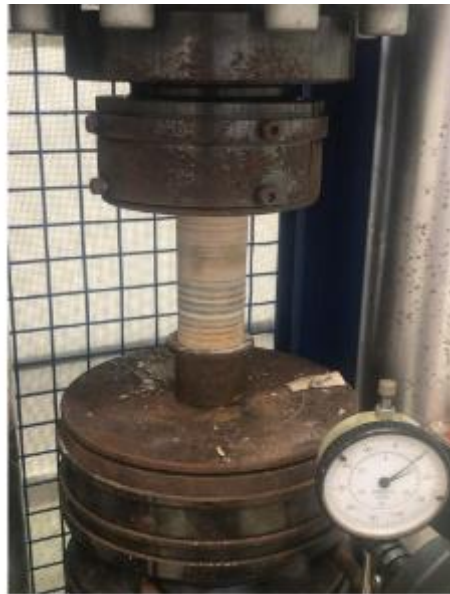
Figura 11 – Arranjo da prensa para a realização do ensaio de compressão uniaxial em amostra de calcário laminado da formação Crato
