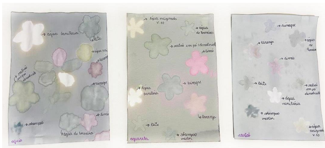
Figura 5 – Testes experimentais em papel sulfite, aquarela e cartão respectivamente.
