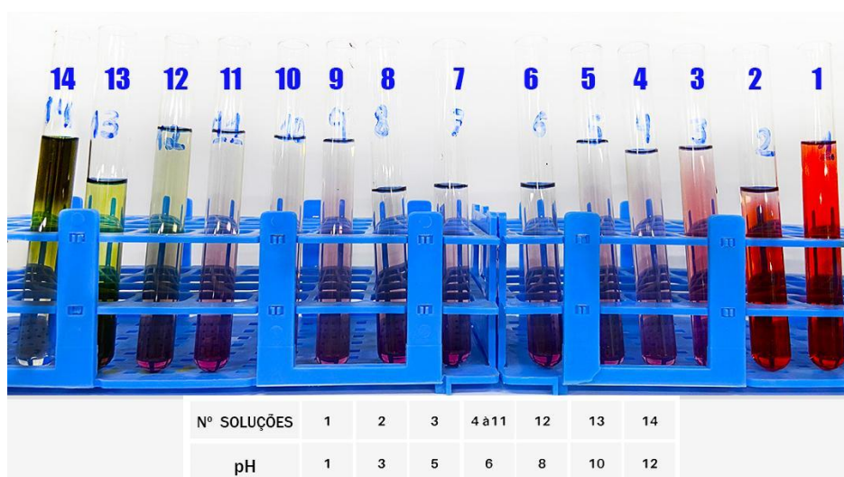
Figura 6 – Intervalo de pH construído através do extrato da flor de Hibiscus rosa-sinensis em soluções diluídas de HCl e NaOH.
