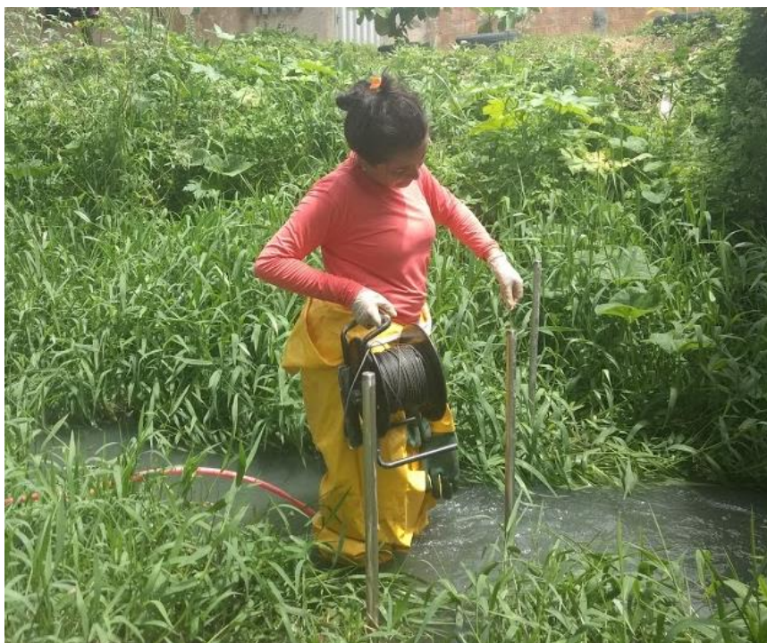
Figura 7 - Leitura da carga hidráulica através de medidor de nível.
