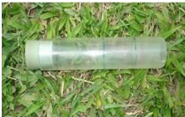
Figura 8 - Amostrador corer utilizado para coletar amostras para o ensaio de granulometria.
