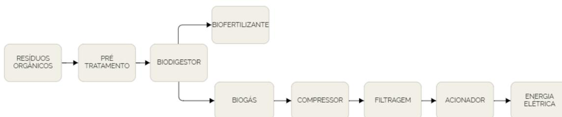
Figura 8. Fluxograma de um típico sistema de biodigestão para a geração de energia elétrica.
