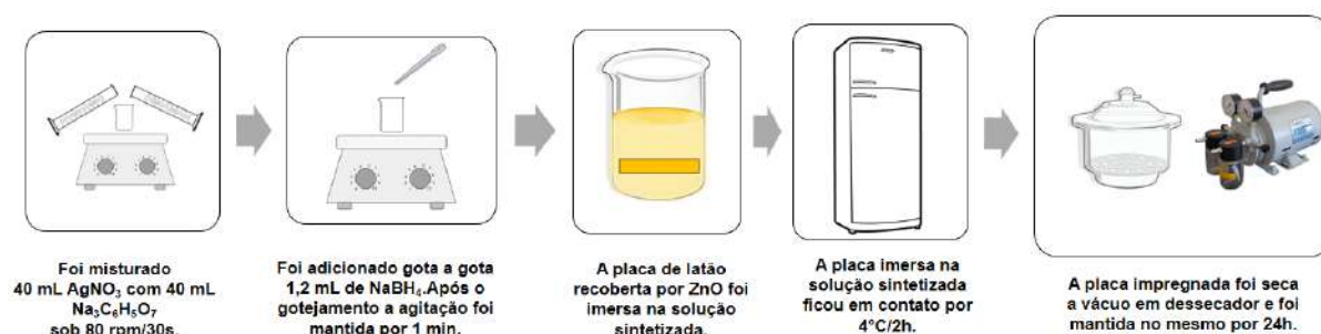
Figura 9- Síntese de NPs de Ag e impregnação com a placa de latão calcinada e imobilizada com ZnO.
