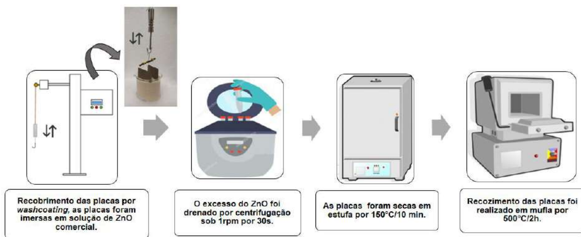
Figura 8- Imobilização das placas de latão.
