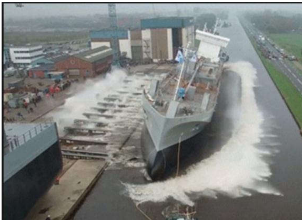
Figura 3: Lançamento de navio através de carreira
