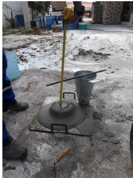
Figura 16 – Verificação do abatimento da amostra de argamassa estabilizada
