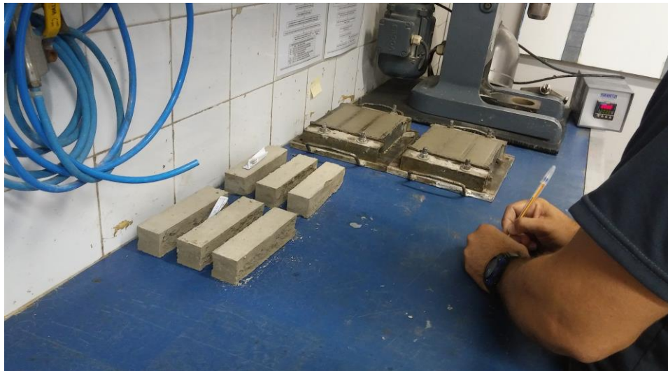
Figura 13 - Corpos de prova desmoldados após 72 horas, ao lado de outros recém-enformados.
