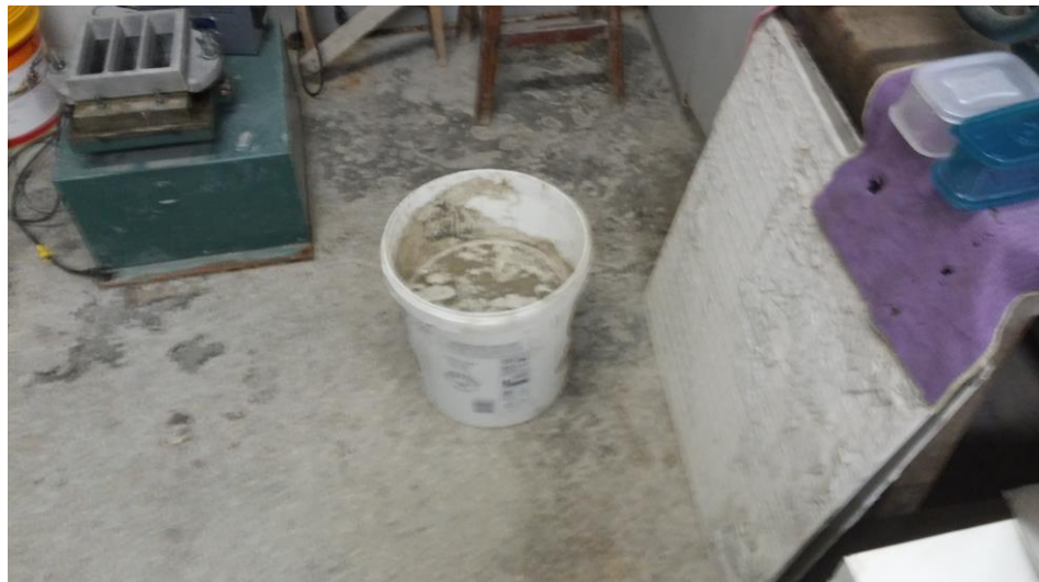
Figura 1 - Argamassa estabilizada com película de água.
