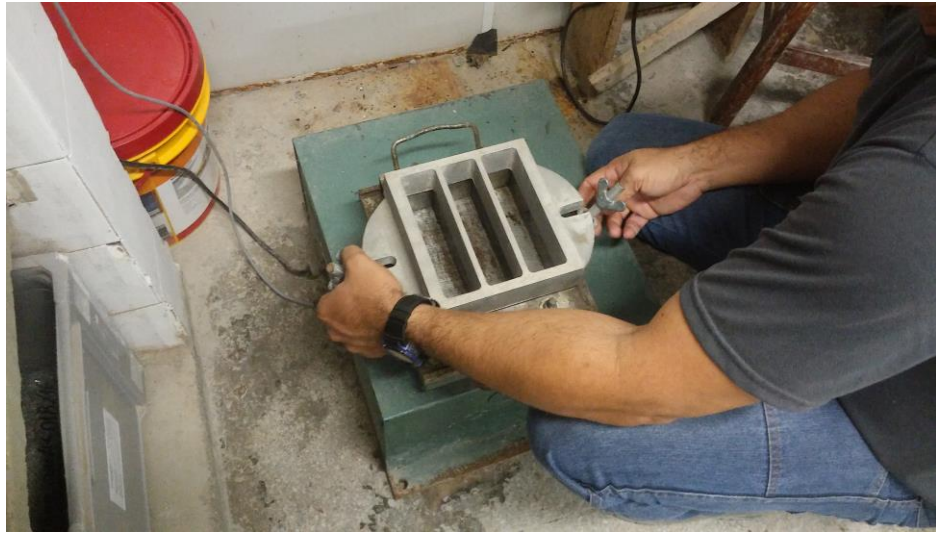
Figura 12 - Montagem do sistema para molde dos corpos de prova.
