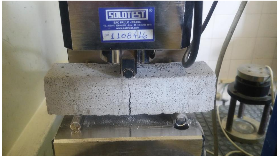
Figura 14 - Realização do ensaio de resistência à tração da argamassa.
