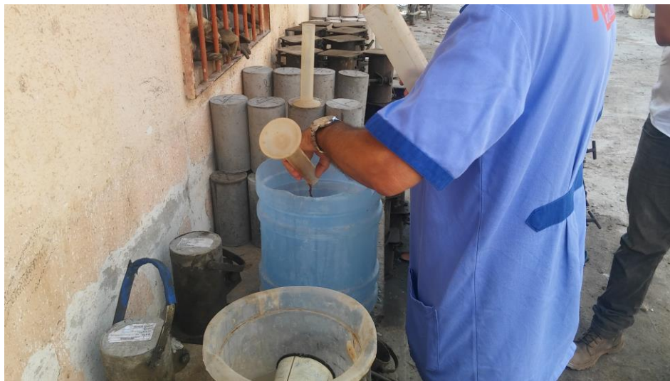
Figura 6 - Mistura dos aditivos com a água
