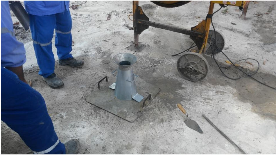
Figura 10 - Preparação para ensaio de abatimento
