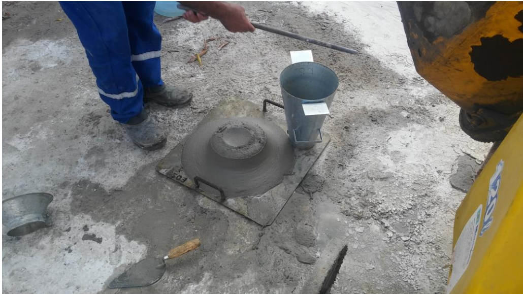
Figura 11 - Verificação do espalhamento da amostra.
