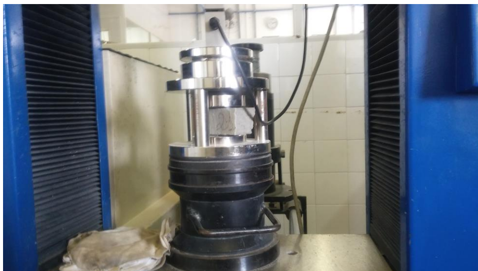
Figura 15 - Realização do ensaio de resistência à compressão da argamassa
