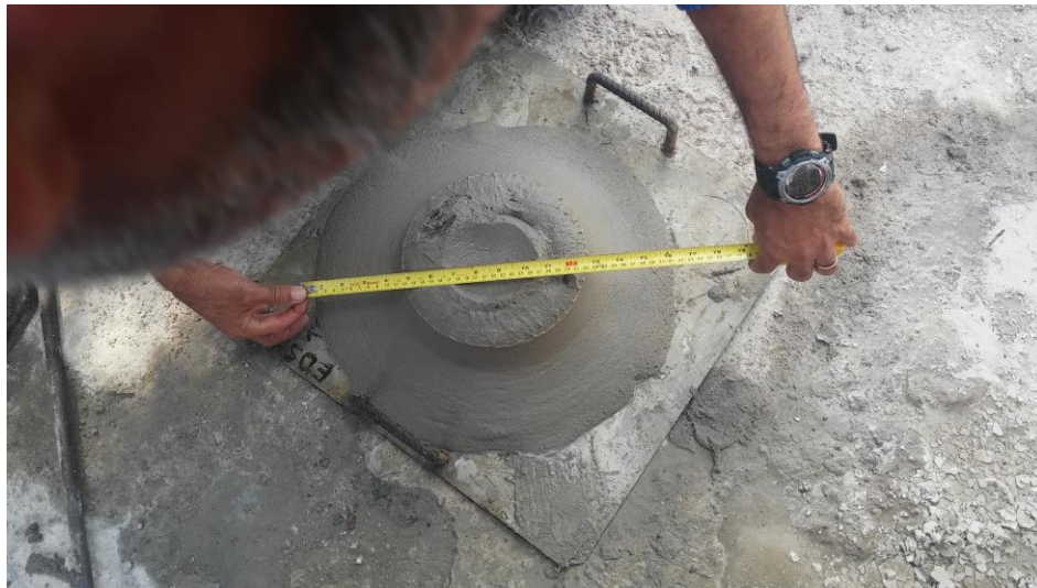
Figura 17 - Realização do ensaio de espalhamento.
