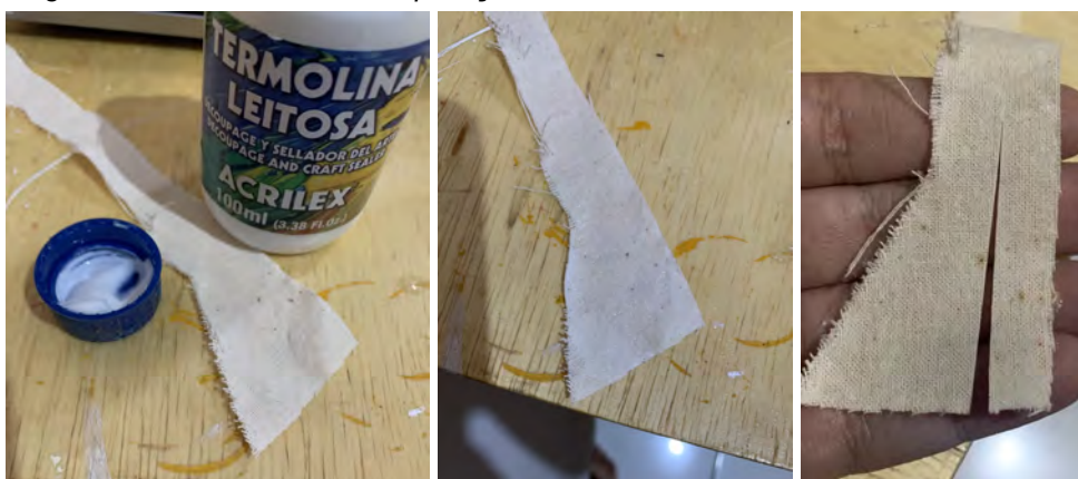
Figura 35, 36 e 37: Teste de aplicação de termolina leitosa em retalho do tecido.
