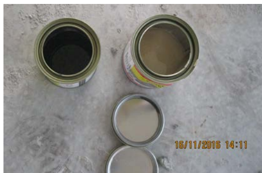
Figura 37 - Adesivo estrutural tixotrópico Componentes A e B
