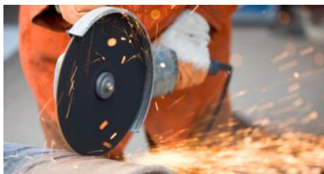
Figura 25 - Corte da tubulação utilizando serra de disco motorizada.
