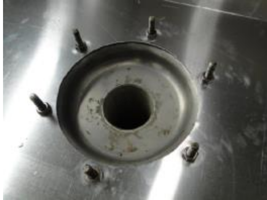
Figura 14 - Captador instalado na calha.
