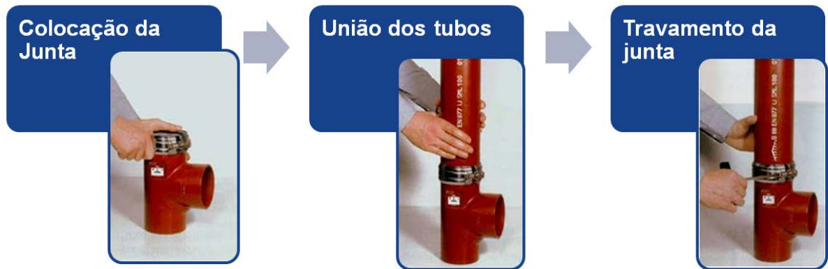
Figura 22 - Utilização da Junta Rapid.
