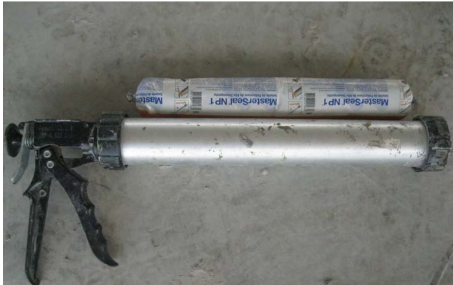
Figura 40 - Material utilizado para colagem da chapa inox na caixa metálica.
