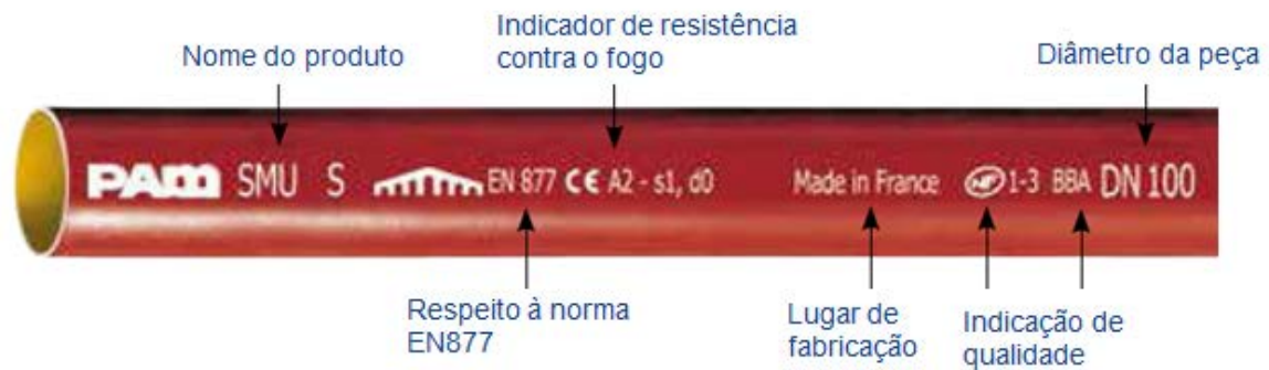
Figura 8 - Tubo de ferro fundido.
