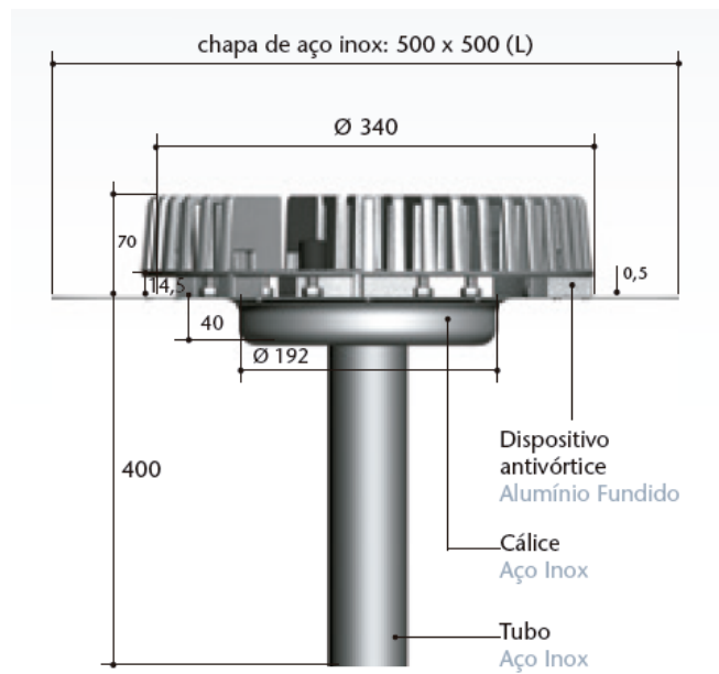
Figura 5 - Captadores anti-vórtice.
